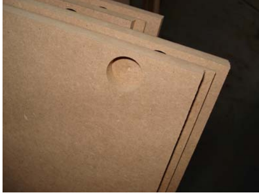
Resim 6.35: Menteşe yeri Açılan Kapak Örneği (Küsket C Blok 16 Nolu Cad 13. Ada 4.Tip No:4)
