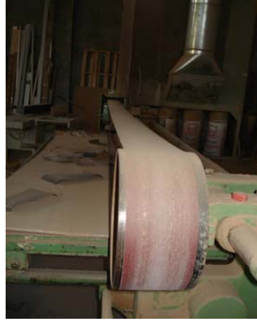
Resim 6.11: Palet Zımpara Makinesinin Zımpara Şerit Görüntüsü (Küsket C Blok 1. Ada 5. tip No:1-4)
