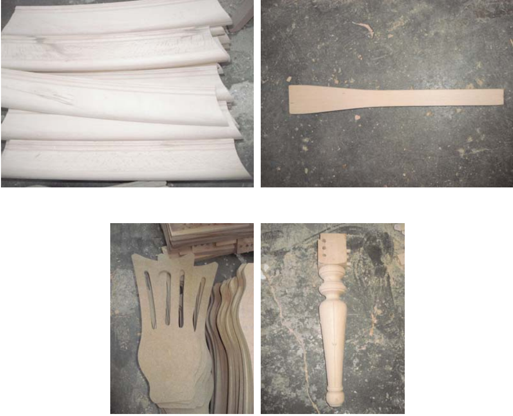
Resim 6.21: Tornadan Geçirilen Dayanma Fondu Üst Şerdi, Çıtası ve Ön Ayak Görüntüsü (Küsket C Blok 14. Ada 28 Nolu Cad. No:56)
