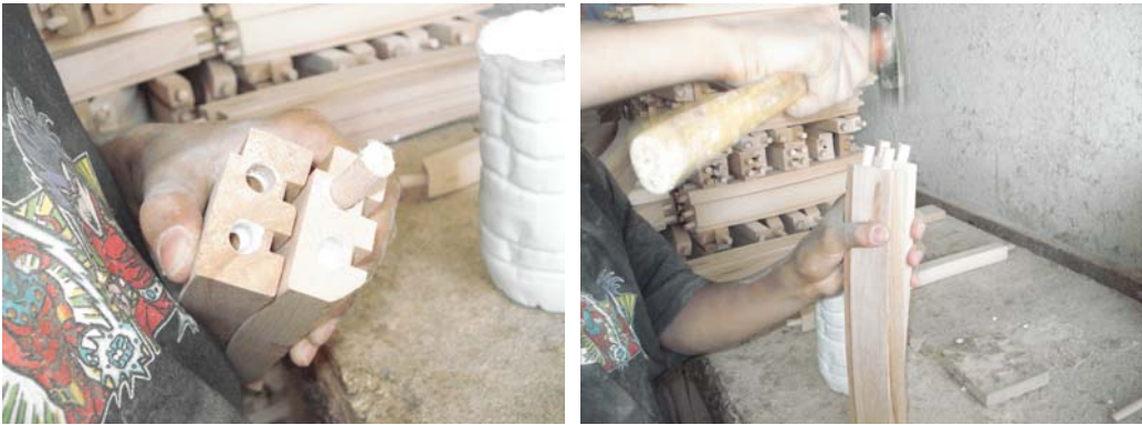
Resim 6.22: Sandalyeyi Oluşturan Parçalara Kavela Çakılma Görüntüsü (Küsket C Blok 14. Ada 28 Nolu Cad. No:56)
