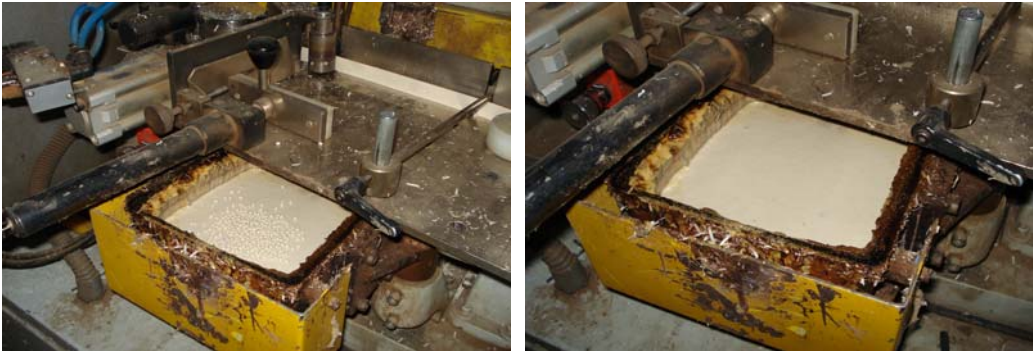
Resim 6.44: Pvc Bant Yapıştırma Kullarılan Tutkal Görünümü (Küsket C Blok 1. Ada 5. tip No:1-4)
