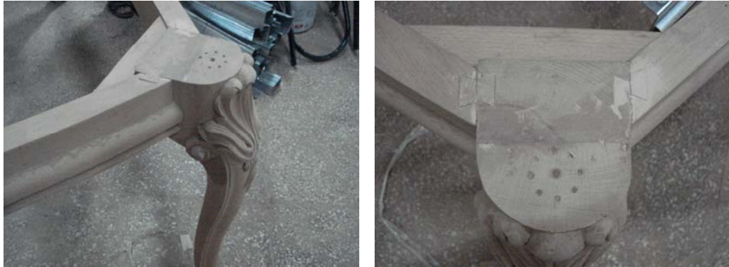
Resim 6.17: Yemek Masasının Tabla Taşıyıcı ve Ayak Birleşim Görüntüleri (Küsket C Blok 16 Nolu Cad 13. Ada 4.Tip No:4)
