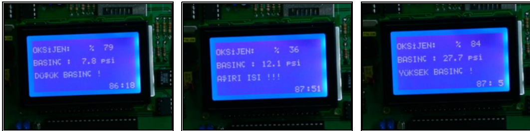
Resim 4.3. Cihazda oluşan arıza bildirim örnekleri
