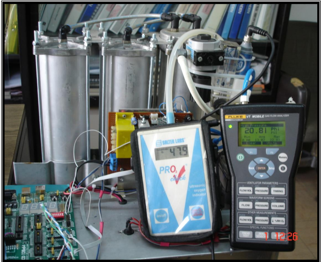
Resim 4.8. Cihazda oksijen ve basınç kalibrasyonu
