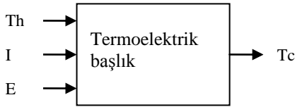
Şekil 2.17. Termoelektrik başlığın blok diyagramı
