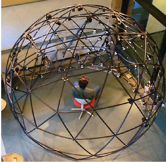
Şekil 5.1. Yale B ve genişletilmiş Yale B yüz veritabanlarının görüntüleme sistemi
