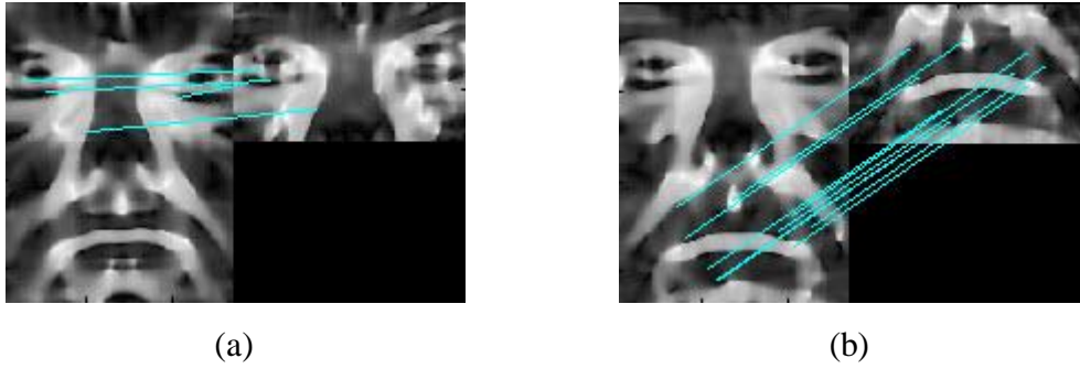
Şekil 4.17. Tüm yüz ile yüzün bir bölümünün SIFT yöntemi ile eşleştirilmesi
