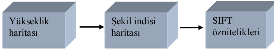
Şekil 4.15. Yükseklik haritasından oluşturulan şekil indislerini kullanarak SIFT özneliklerinin bulunma diyagramı
