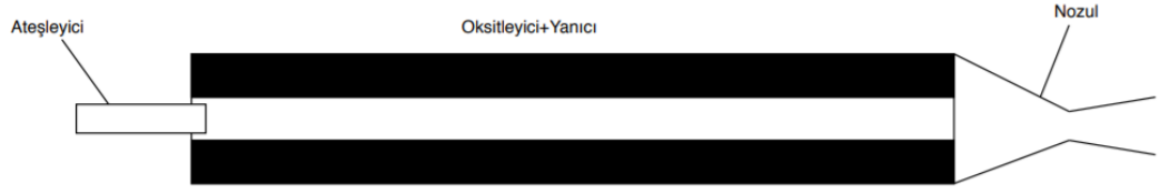
Şekil 1.5 Katı Yakıtlı Roket Motorunun şematik modeli
