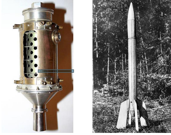
Şekil 1.1 GIRD 9 Yanma odası ve tüm roket (Barato, 2013)
