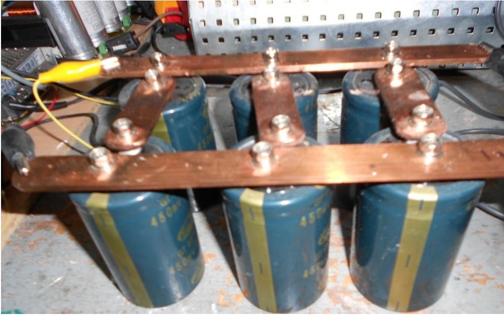
Resim 6.9. FV panellere paralel bağlanan kondansatörlerin fotoğrafı
