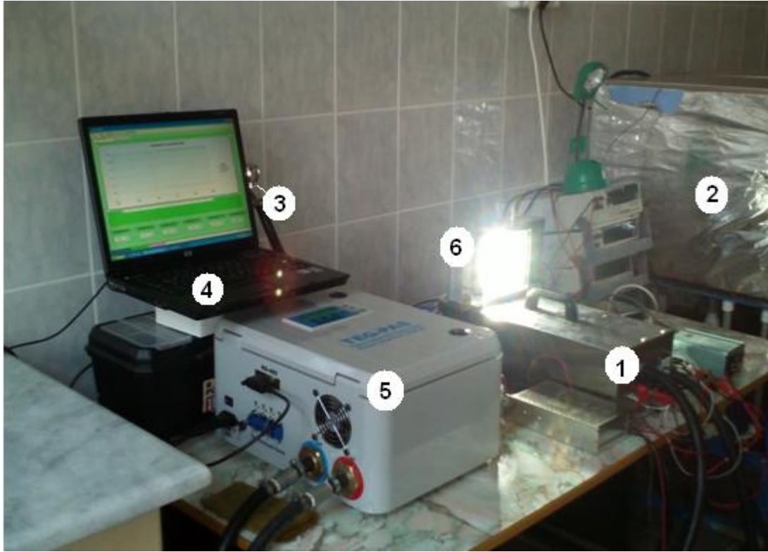
Resim 5.2. 100 W ticari portatif yeni TEJ sistemi deneysel kurulumu
