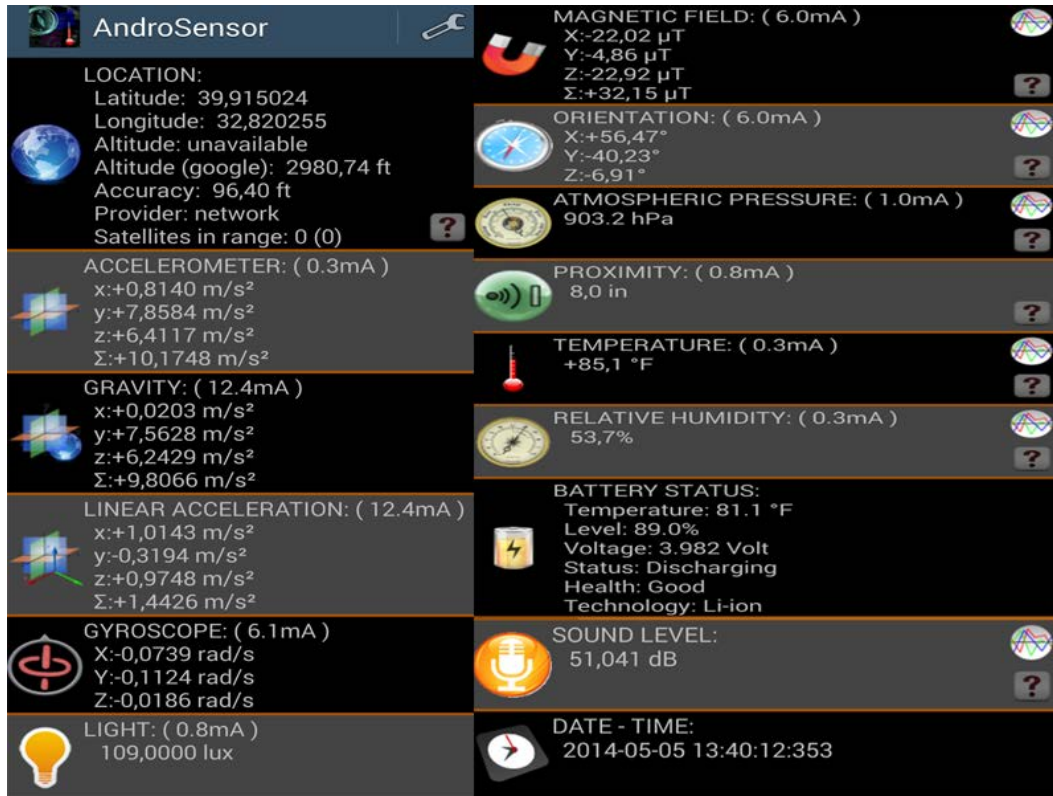
Resim 4.2. AndroSensor uygulaması ile Samsung S4 akıllı telefon üzerindeki sensörlerin anlık görüntüsü ve ulaşılan bağlantılara ilişkin veriler
