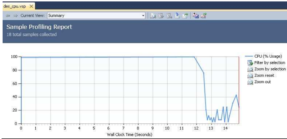
Resim 7.41. DES algoritması ile şifreleme işlemi CPU grafiği
