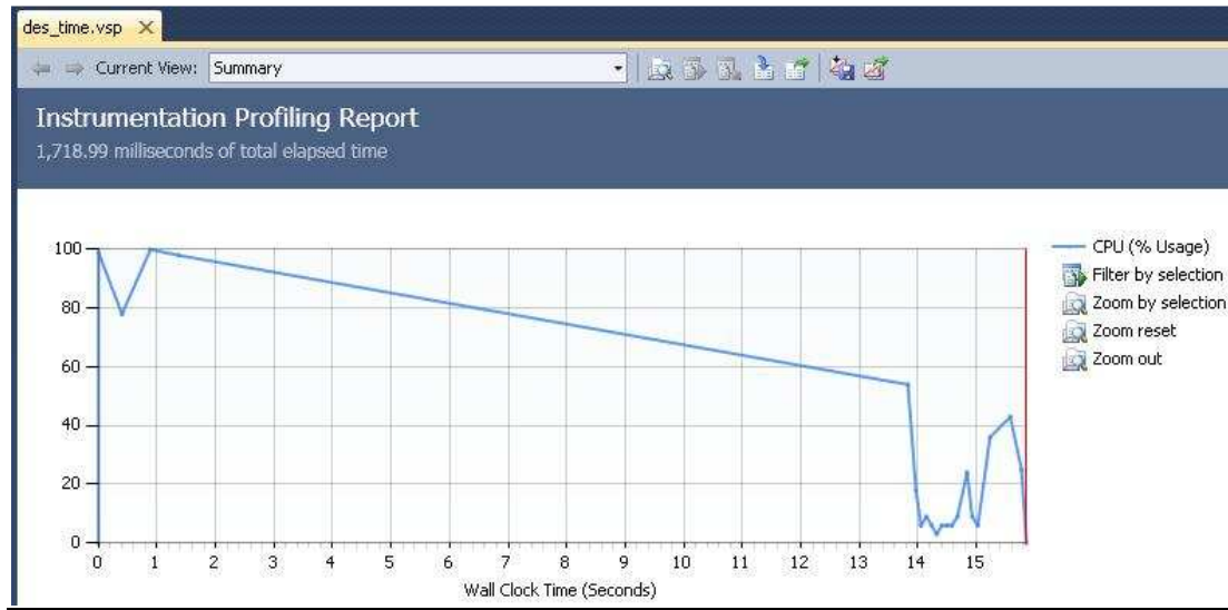
Resim 7.54. DES algoritması işlem zamanı-CPU grafiği
