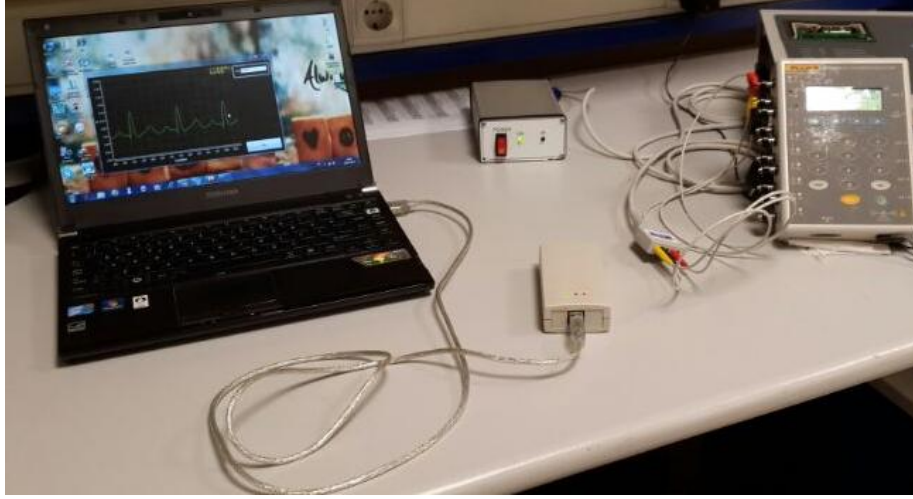
Resim 4.7. Tasarlanan sistemin EKG simülatörü kullanılarak uygulaması
