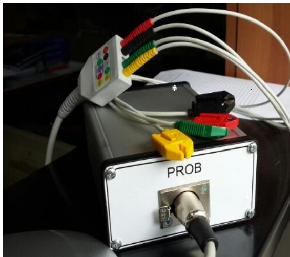
Resim 6.2. Optik verici kısım prob bağlantısı
