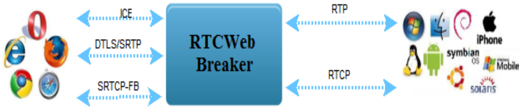
Şekil 4.3. Webrtc2sip RTCWeb breaker modülü (Dobango Telecom, 2013)
