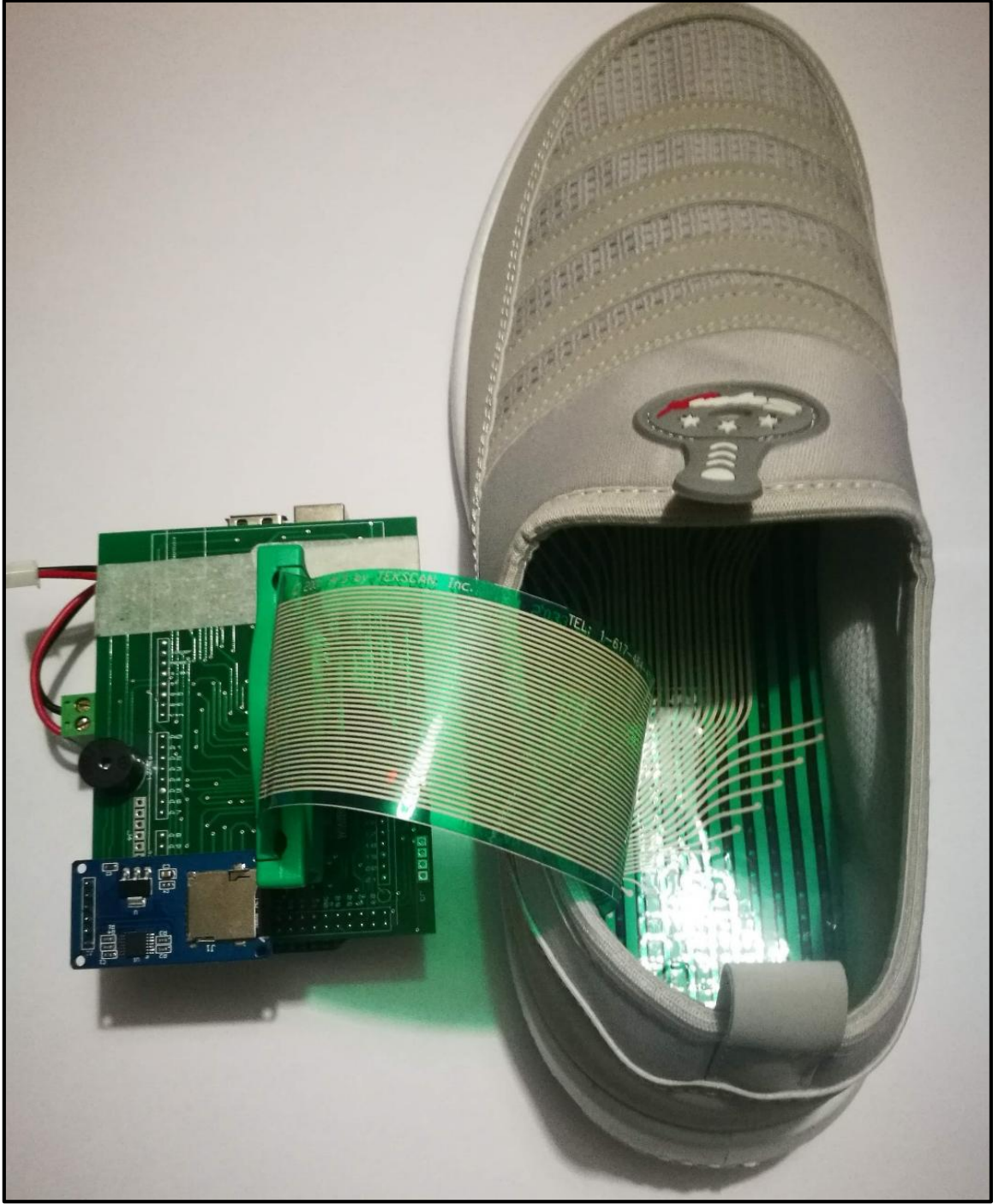
Resim 4.9. Gerçekleştirilen ayakkabı modülünün son hali
