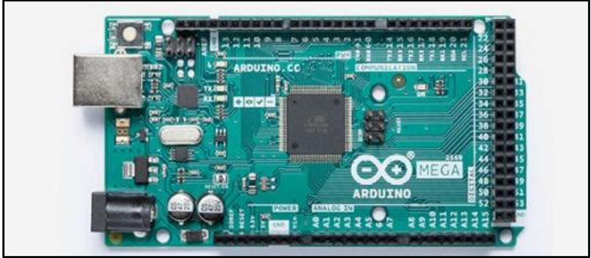
Resim 3.4. Arduino Mega ADK 2560 [24]
