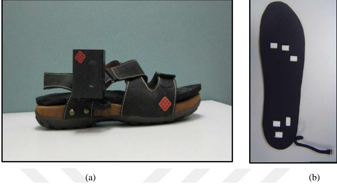
Resim 2.3. Lin Shu ve arkadaşları tarafından geliştirilen plantar basınç ölçüm sistemi [8]
