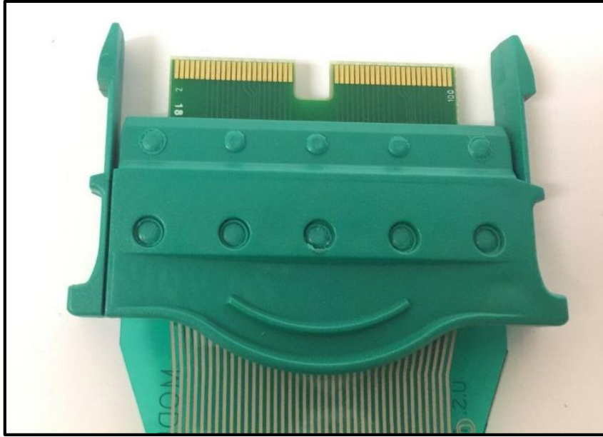
Resim 3.3. Tekscan Medical Sensor 3000E bağlantı ara yüzü
