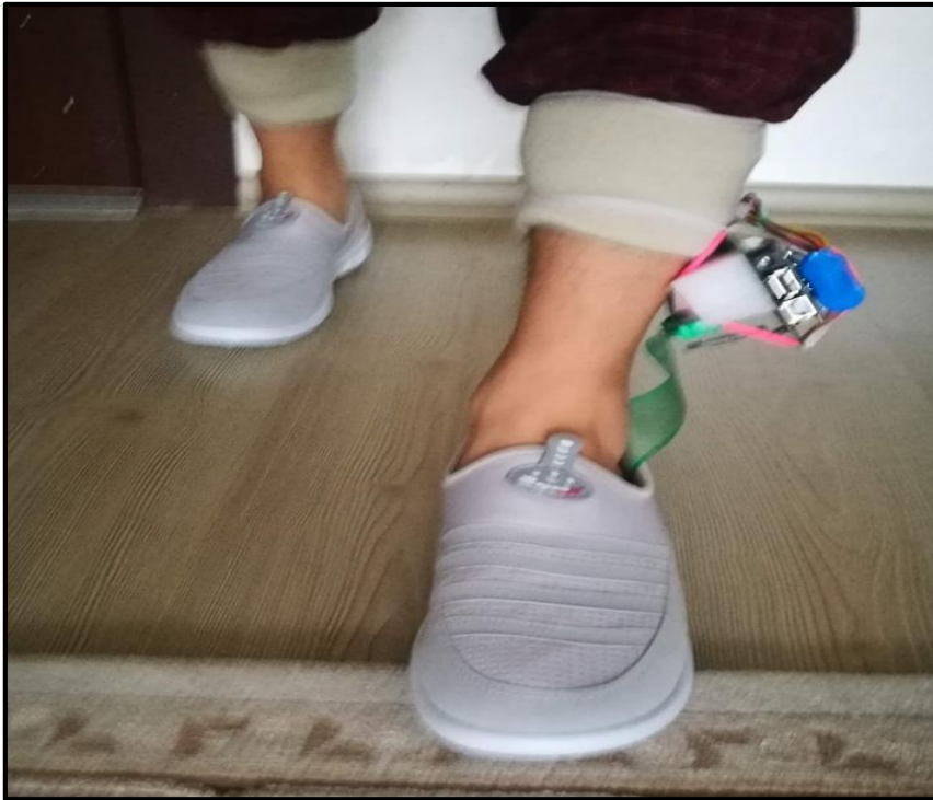
Resim 5.3. Ayakkabı modülüyle yapılan yürüme testi
