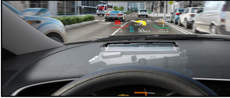
Resim 2.15: Lincoln DMD yansıtıcı (İnternet: Lincoln, Artırılmış Gerçeklikli Ön Cam Kullanan İlk Otomobil Olacak, 2017)
