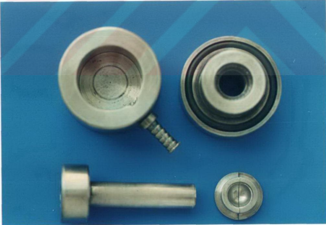
Fotoğraf 9: Farklı geometrik şekilli tablet kalıplarından, elipsoid geometrik şekilli tablet kalıbı
