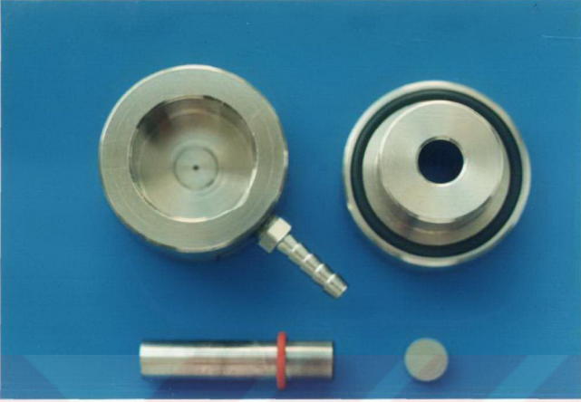
Fotoğraf 8: Farklı geometrik şekilli tablet kalıplarından, silindir geometrik şekilli tablet kalıbı
