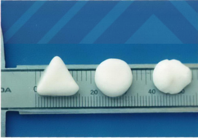
Fotoğraf 11: Salım hızı kontrolü sırasında, 2. saat sonunda ortamdan alınmış, üçgen, silindirik ve elipsoid (1:1%40) matris tabletler
