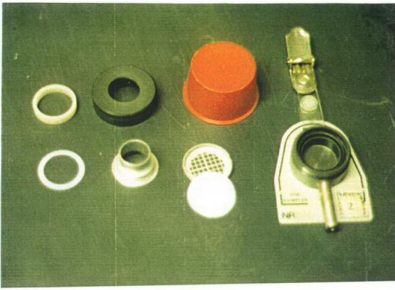
Resim 1: Kişisel toz toplayıcısının başlığının parçaları
