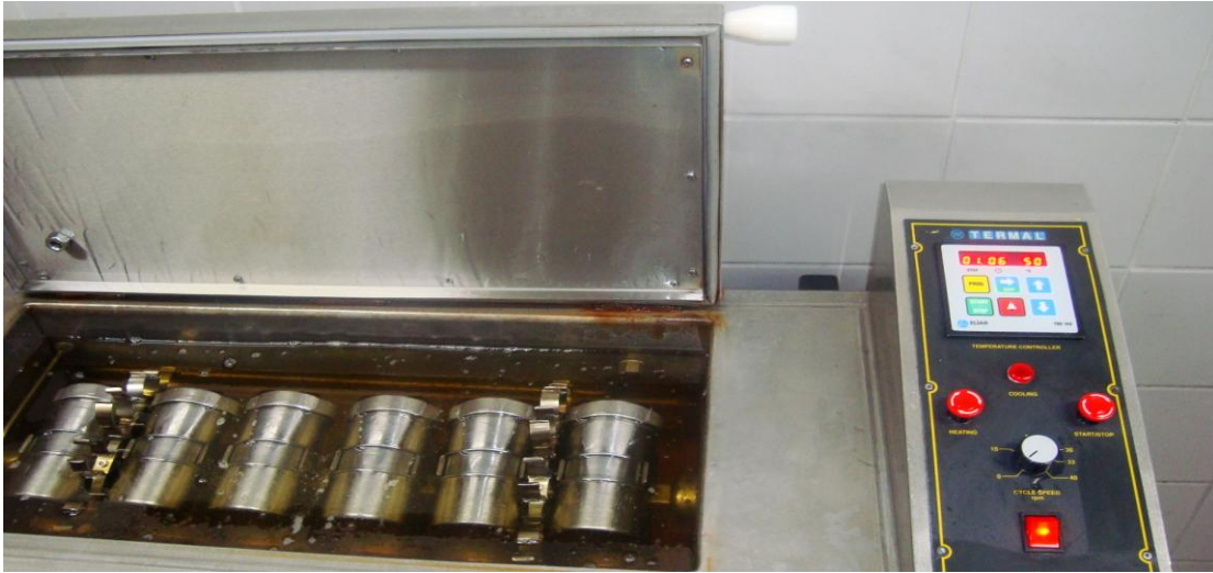
Şekil-30 Termal Boya Makinesi içine yerleştirilmiş test kapları
