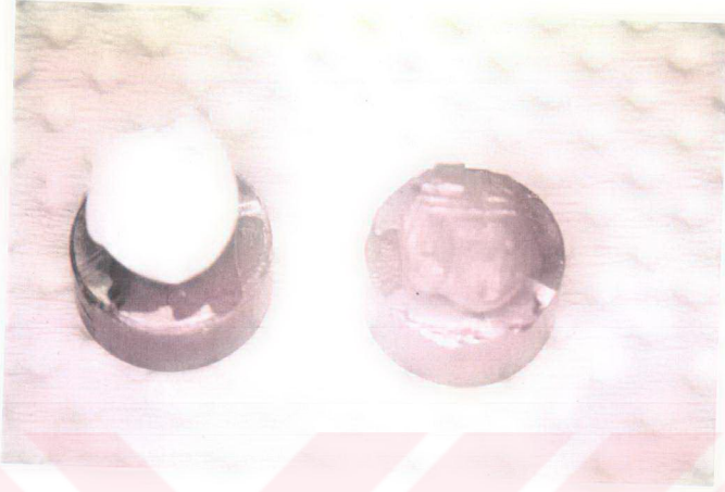
Resim 5. SEM incelemesi için pirinç örnek taşıyıcıya yapıştırılan yaklaşık 200 Å kalınlığında altınla kaplanan örnekler.
