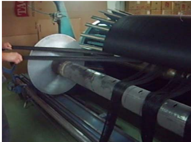
Şekil 11. Konik tambura sarılan çözümlerin levende aktarılması (Plasmen Endüstri Ticaret A.Ş. )
