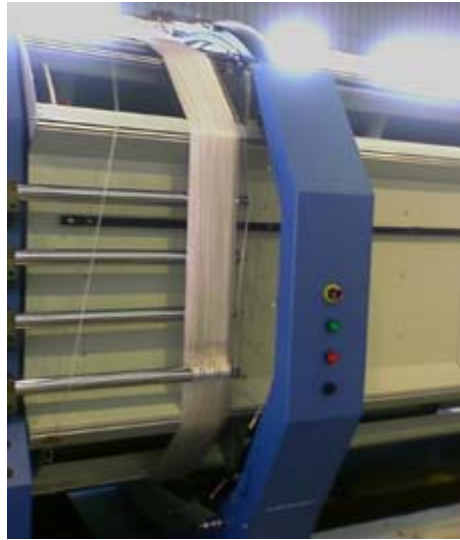
Şekil 18. Lutan v5.0'nın iplik kılavuzları ve çapraz çubukları (Miren Tekstil Tic. Ltd. Şti.)
