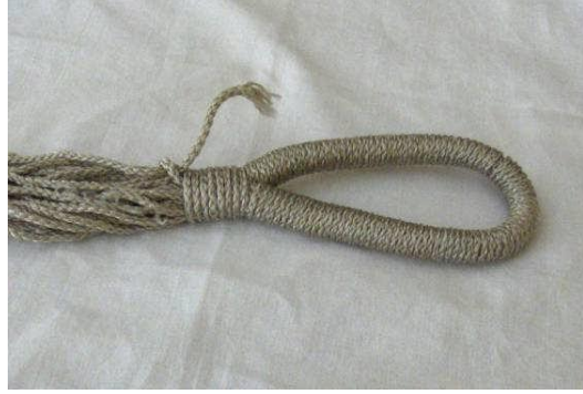
Şekil No 57: Tepe Noktasının Sarılmasının Tamamlanması
