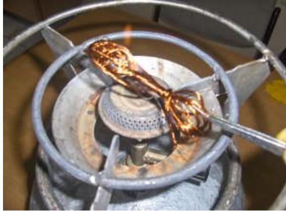
Şekil No 125: Telin Yakılarak Oksitlenmesi
