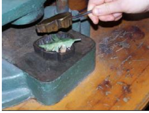
Şekil No 220: Yaprakların Kalıba Yerleştirilmesi
