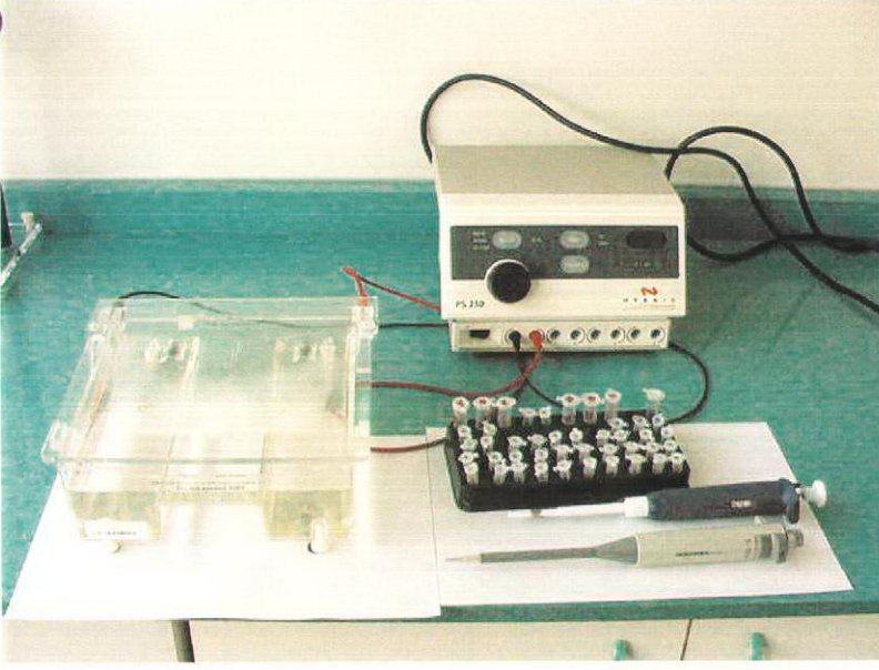
Resim 7: Amplifiye DNA'ların %1.75'lik agaroz jel elektroforezinde yürütülmesi
