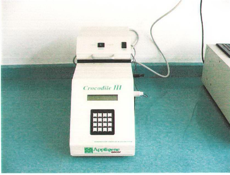
Resim 6: Polimeraz zincir reaksiyonunun gerçekleştirildiği thermal cycler
