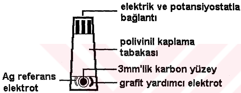
Şekil 4: Perde baskılı karbon (grafit) elektrodun şematik gösterimi.
