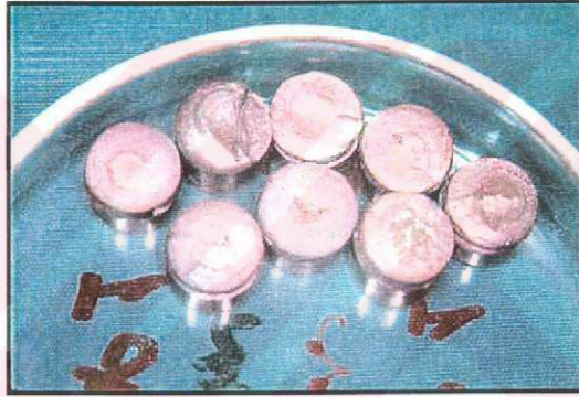
Resim 16. Makaslama testinden sonra altın kaplama yapılmış örnekler
