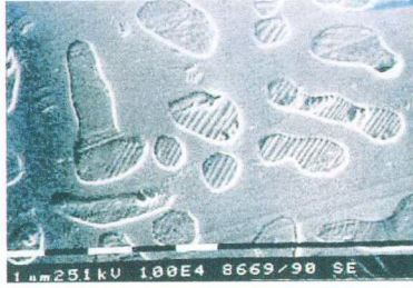
Resim 1- Lüsit kristallerinin taramalı elektron mikroskop görüntüsü (34)
