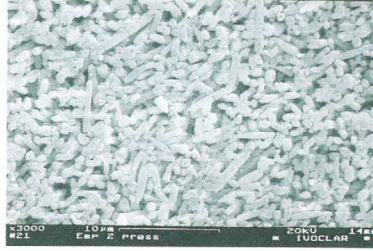
Resim 4- Lityum disilikat kristallerinin çekirdek alt yapı preslendikten sonraki görüntüsü (35)
