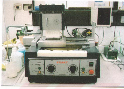
Resim 13- EXAKT sistemindeki aşındırma ve polisaj cihazı
