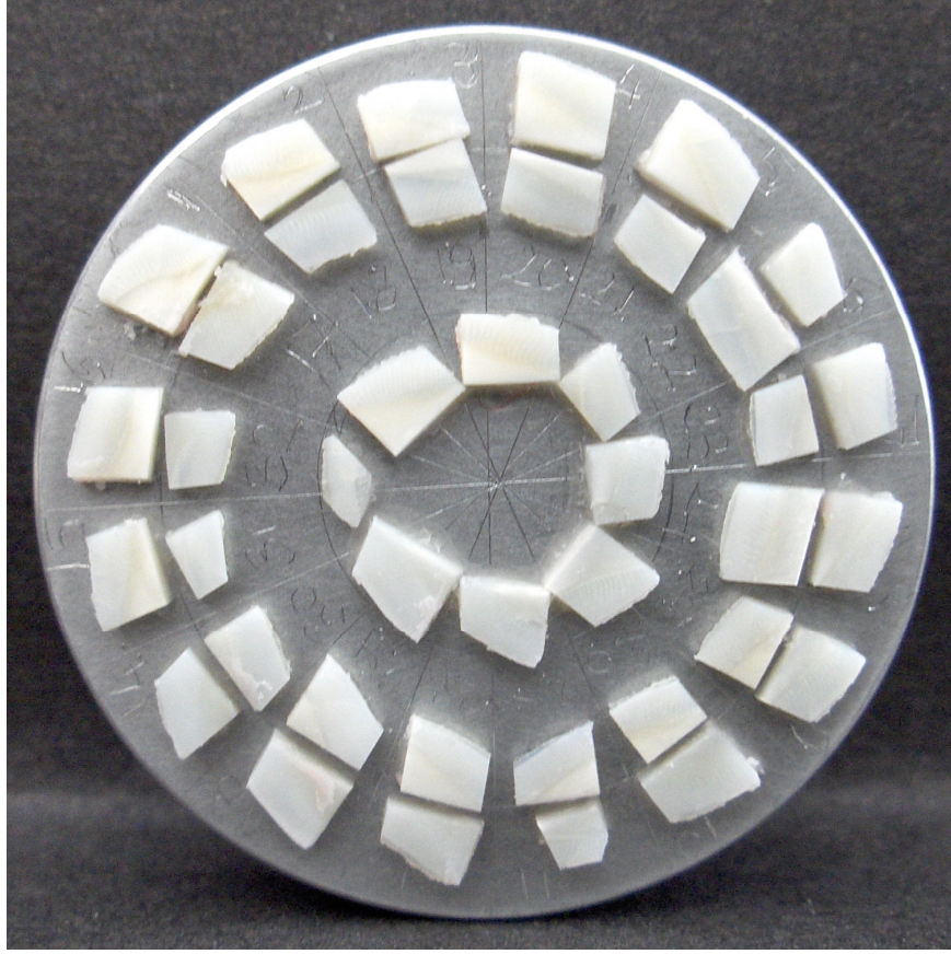
Resim 14: Alüminyum tablaya yapıştırılmış örnekler
