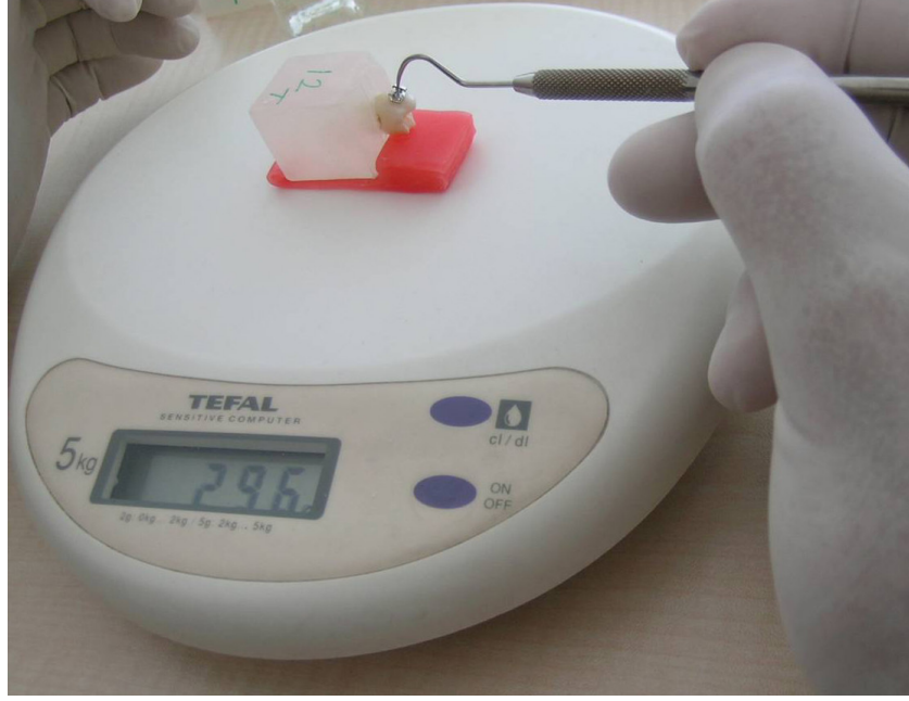
Resim 6: Dijital tartı yardımıyla dişlere uygulanan kuvvetin ölçülmesi
