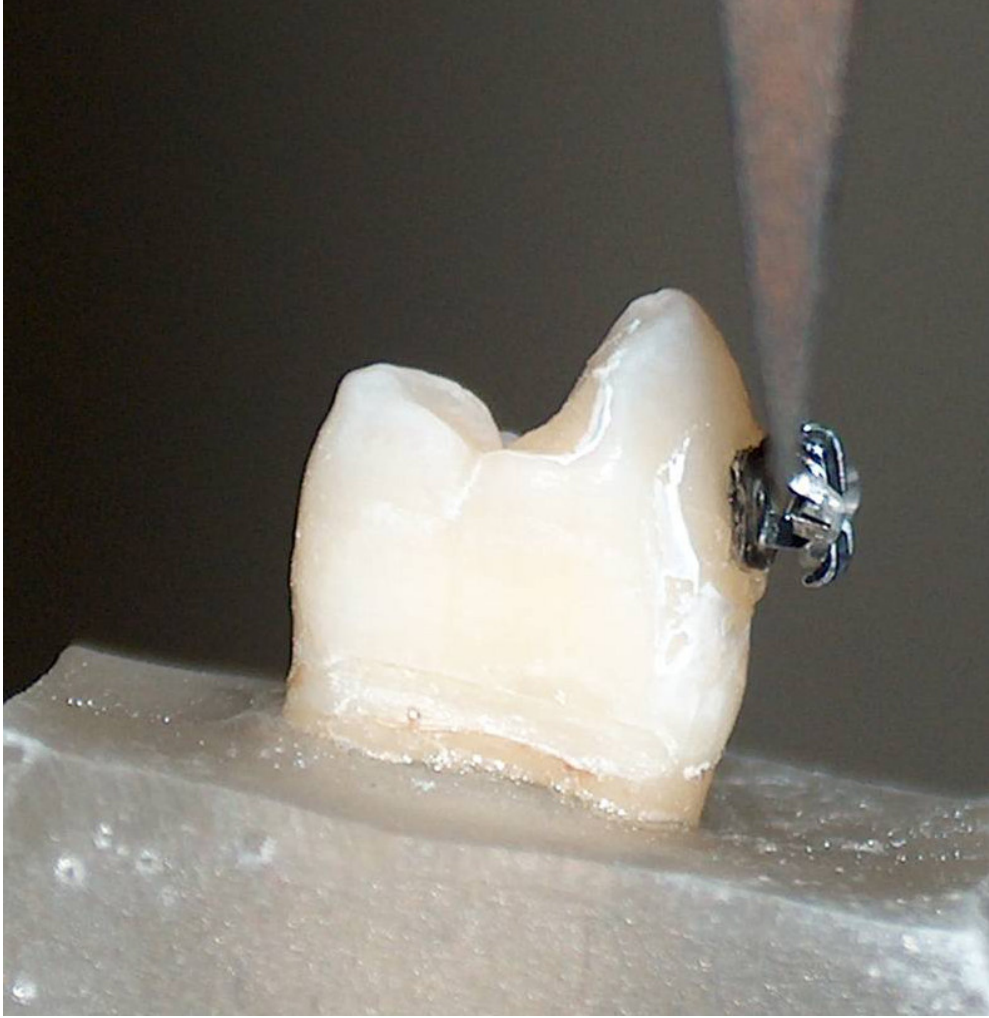
Resim 12: Örneğin, test cihazının bıçağının altında, braket tabanı bıçağın uzun eksenine paralel olacak şekilde sabitlenmiş hali
