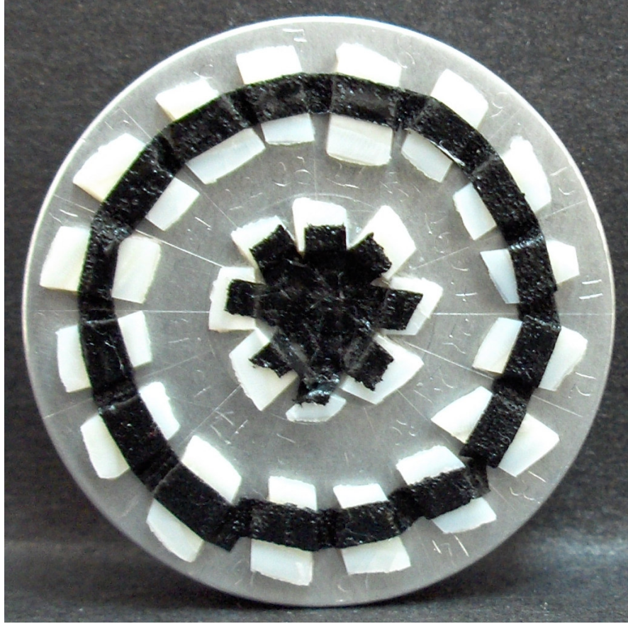
Resim 17: Örneklerin karbon bant ile kaplanmış hali
