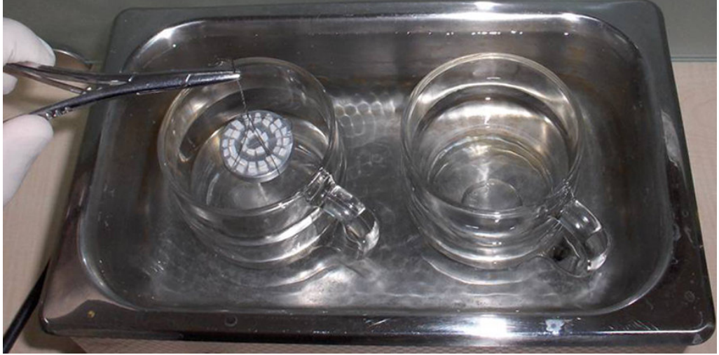
Resim 16: Örnekler 0.01 mol/l HCL içinde dađlanırken
