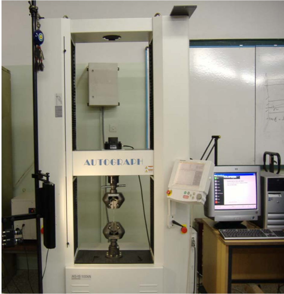
Resim 11 Basma dayanıklılığı testi yapılan Autograph cihazı
