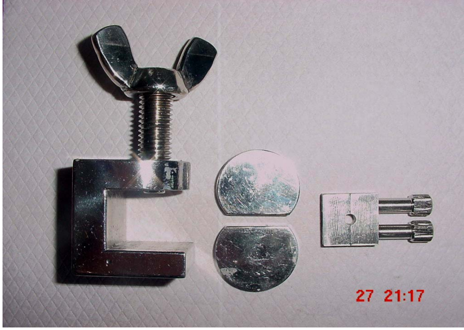
Resim 10 Basma dayanıklılığı testi için kullanılan 4\pm 0,1 mm çap ve 6\pm 0,1 mm kalınlıkta örnek kalıpları ve mengene
