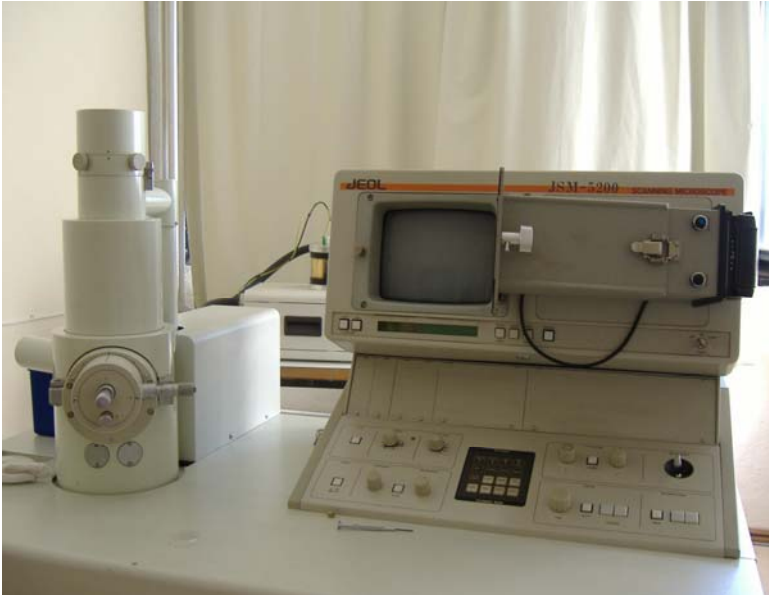
Resim 19 Çalışmamızda kullanılan JEOL-JSM-5200 (Tokyo, JAPONYA) Taramalı Elektron Mikroskobu
