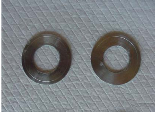
Resim 20 Radyopasite testi için hazırlanmış 15±1mm çap ve 1±0,1mm kalınlıktaki örnek kalıpları
