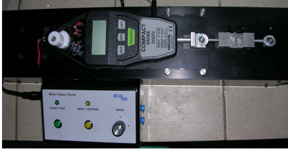
Resim 31: Mikrogerilme cihazı ve ona yerleştirilen Bencor Multi T aparatı
