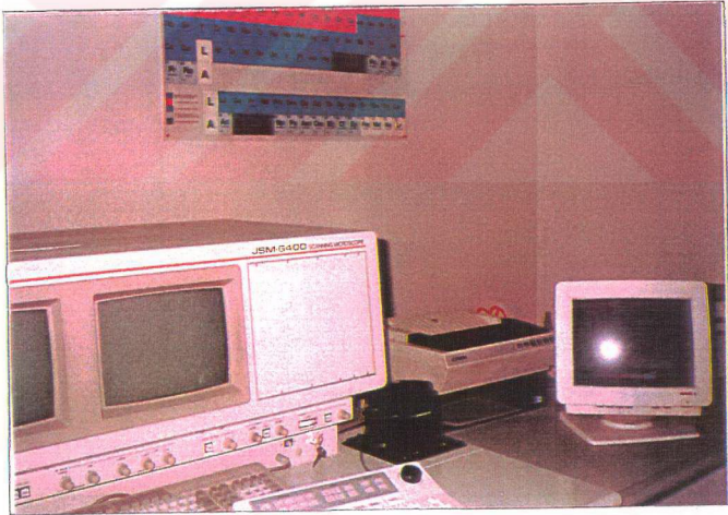
Resim III.16 : SEM'e bağı EDAX analiz ünitesi.
