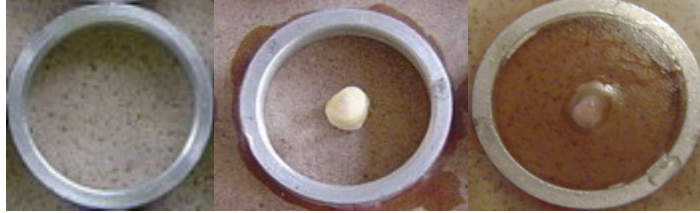
Resim 4. Polyester disklerin hazırlanması
