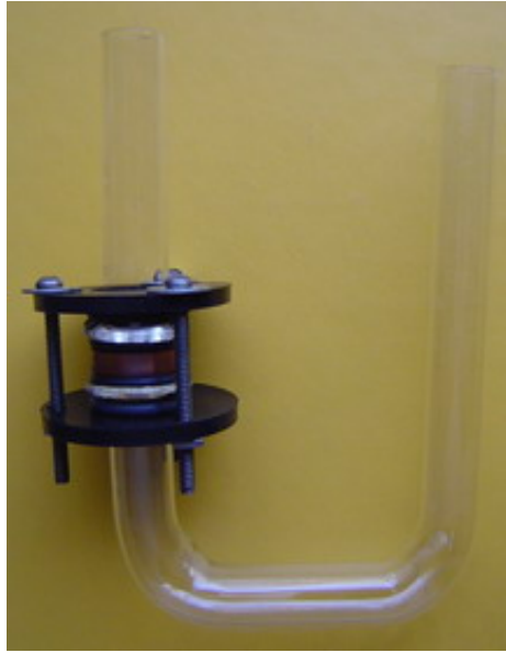
Resim 24. Difüzyon apareyinin kurulması
