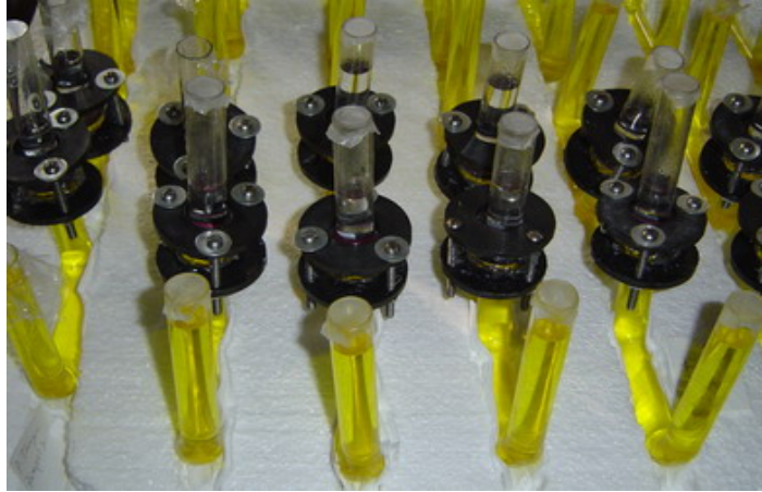
Resim 25. Radyokimyasal sıvı ile dolu difüzyon apareyleri
