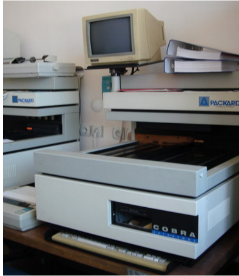
Resim 27. Packard marka Auto-Gamma 5002 model gamma spektrometre sistemi
