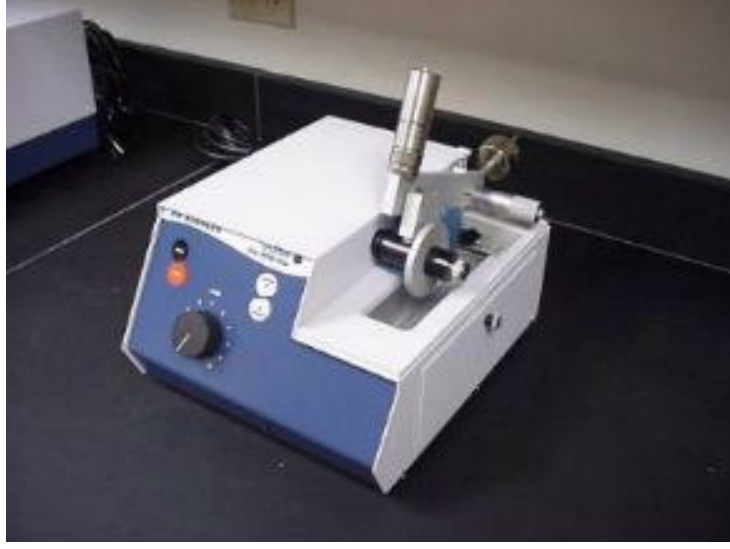
Şekil 21: Düşük hızlı izomet testere ( Low speed Isomet saw, Buehler, Lake Bluff, Illinois, ABD)
