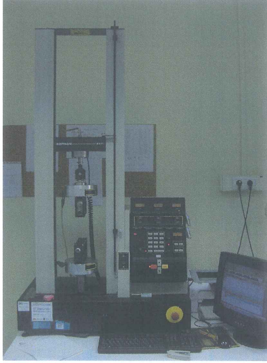
Şekil 15. Kopma mukavemeti test cihazı (Ekoteks)
