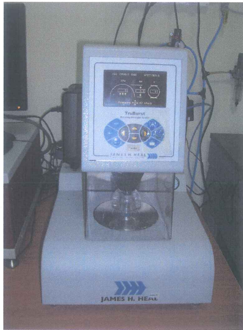
Şekil 17. Patlama mukavemeti (pnömatik metot) test cihazı (Ekoteks)
