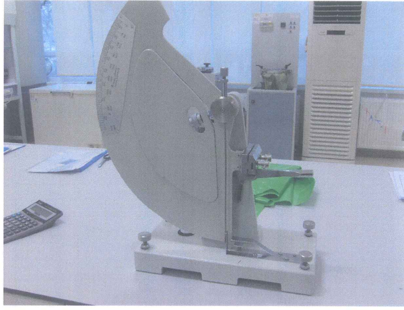
Şekil 13. Balistik sarkaç metodu test cihazı (Teknoteks)
