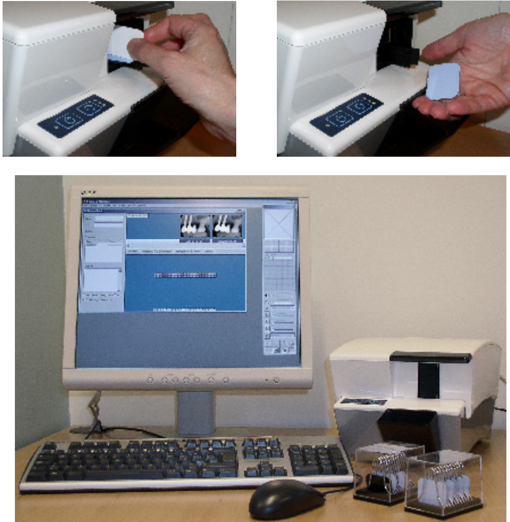
Resim 28: Digora plaklarının ışınlamayı takiben Digora® Optime-tarayıcı yardımıyla taranıp dijital ortama aktarılması
