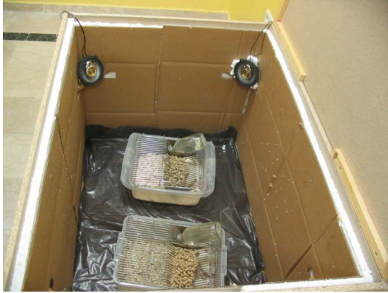
Şekil 7. Deneklere Gürültünün Uygulandığı Ses İzolasyonlu Kafes
