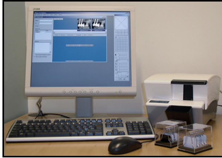
Resim 7. Digora plaklarının ışınlamayı takiben Digora® Optime-tarayıcı yardımıyla taranıp dijital ortama aktarılması
