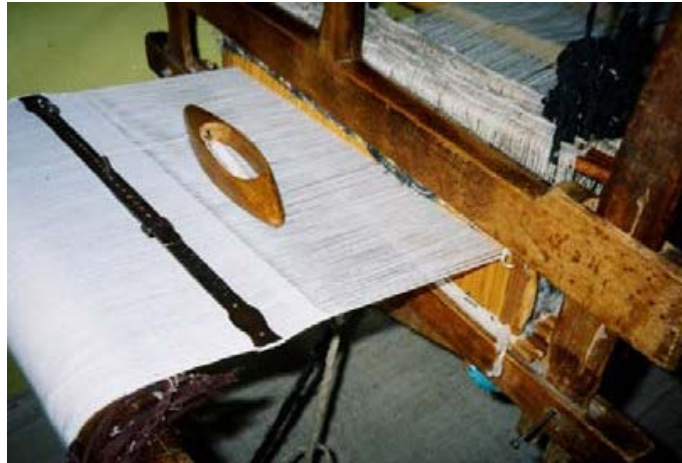
Şekil 13: Çımbarın Tezgahta Kullanımı
