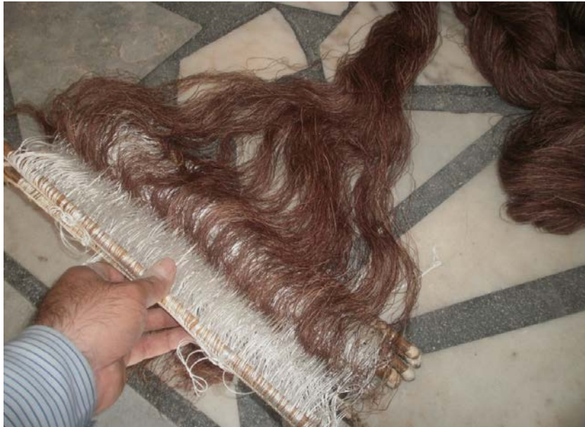
Şekil 123: Çözü İplikleri Geçirilmiş Gücüler
