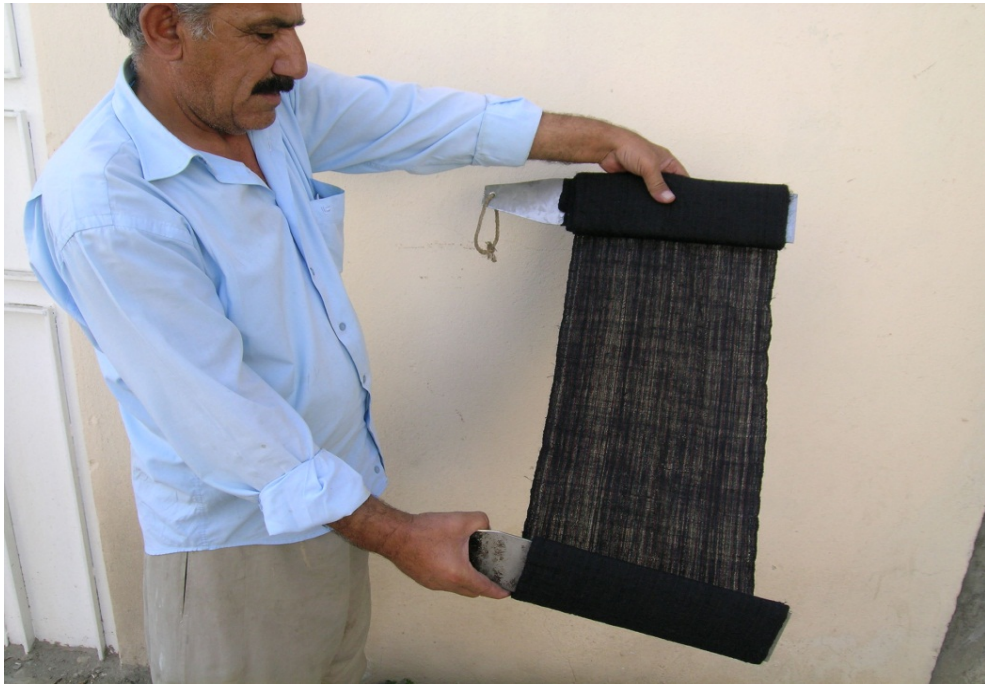
Şekil 143: Çelik Levhaya Eşit Şekilde Sarılmış Şal Şapık
