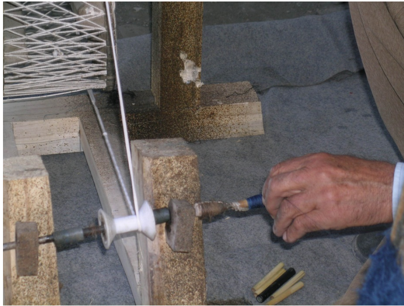
Şekil 95: Masuraya İplik Sarmada Yön Verme
