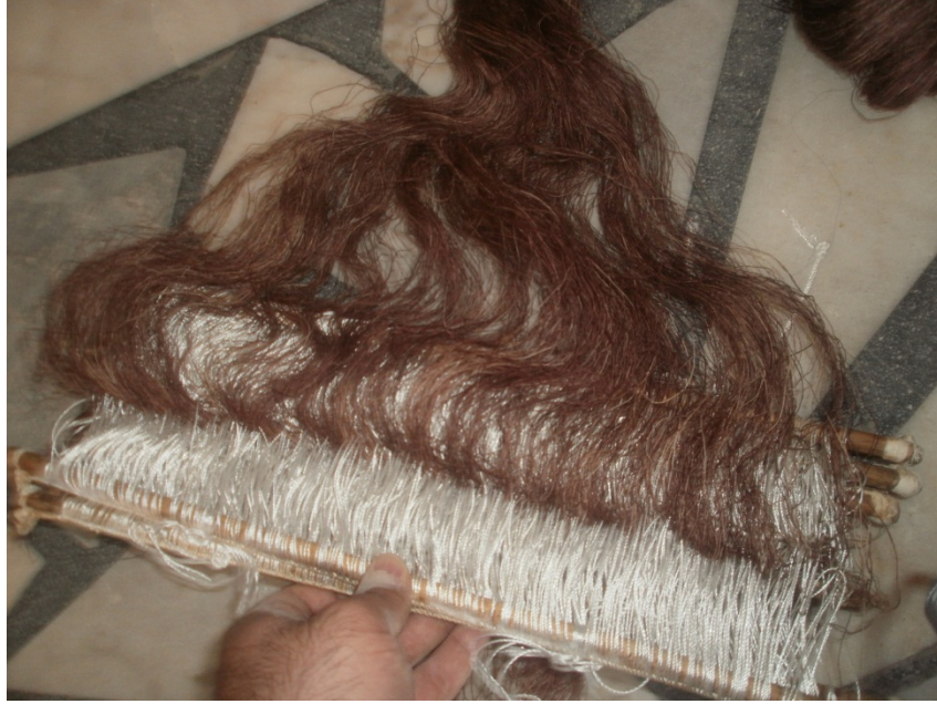
Şekil 33: Çözgü Geçirilmiş İp Gücüler
