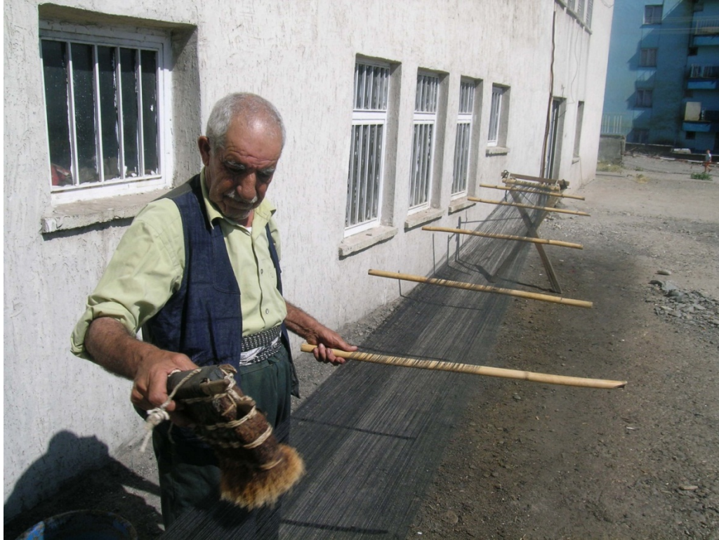
Şekil 113: Çirişin Fırçalama İşlemi İle Çözüye Uygulanması
