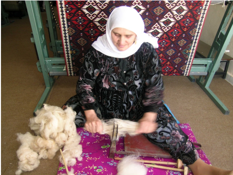
Şekil 76: Demir Tarakta Tiftik Tarama Genel Görünüşü (Şırnak Halk Eğitim Merkezi, 2012)
