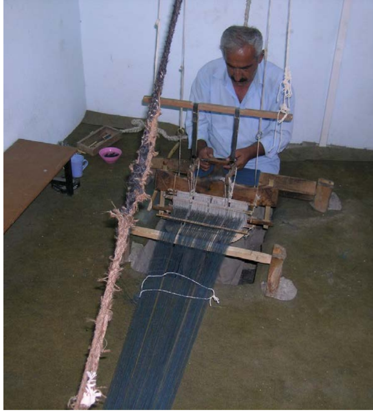
Şekil 29: Çukur Tezgahta Dokuyucunun Görünümü
