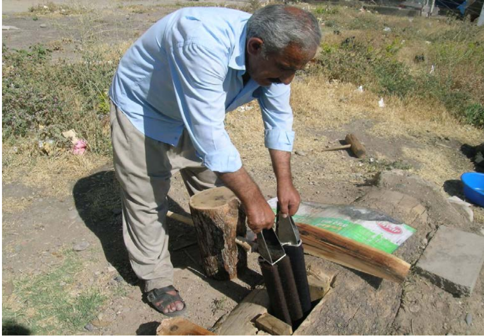
Şekil 146: Kaynatmadan Çıkan Çelik Levhaların Prese Yerleştirilmesi
