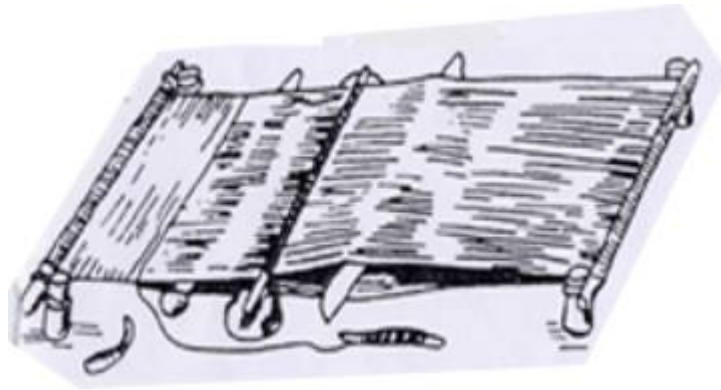
Şekil 5: Basit Bir Yatay Yer Tezgahı Örneği (Büken, 2004, s.78).
