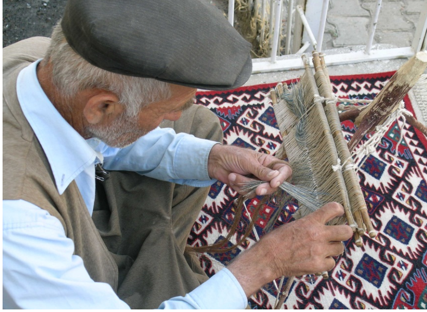
Şekil 122: Gücülerden Çözü İpliğinin Geçirilmesi
