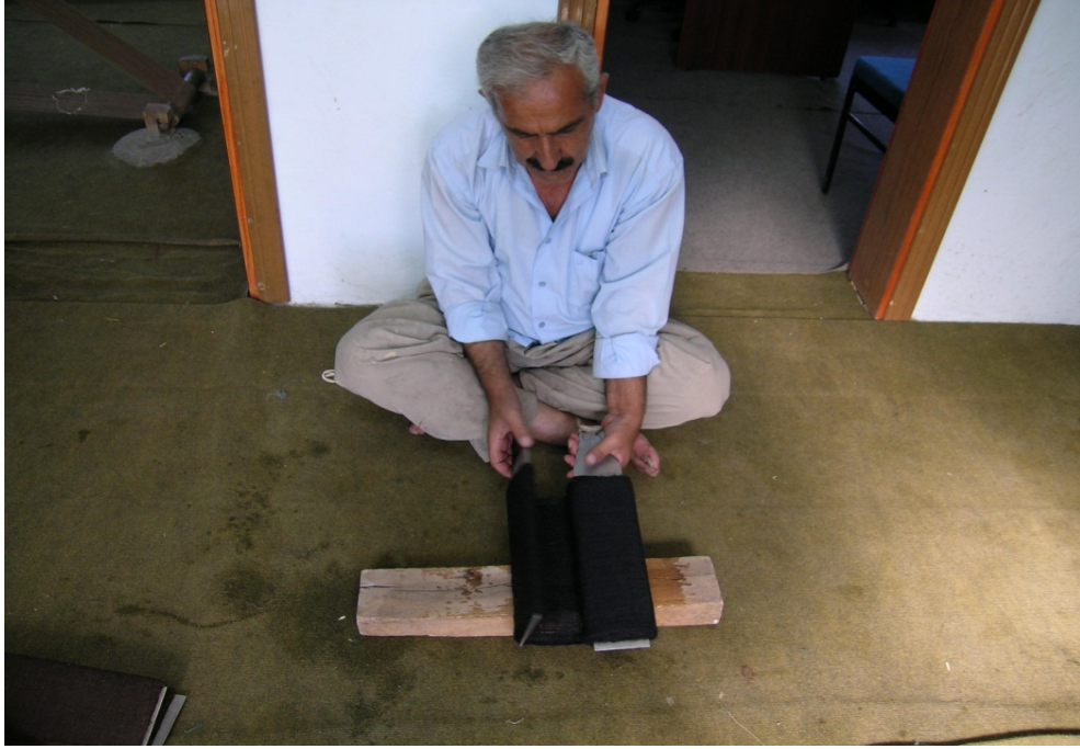
Şekil 142: Şal Şapık Kumaşın İkinci Çelik Levhaya Sarılması
