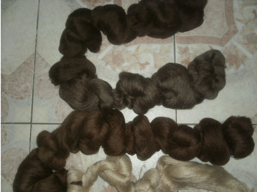
Şekil 114: Çirişlenmiş Kurutulmuş Çözü İplikleri
