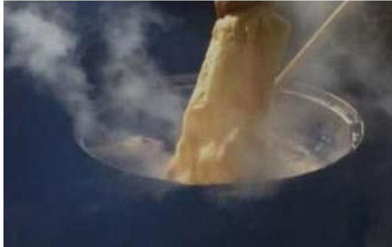
Şekil 83: Boya Kazanına Daldırılan Şal Şapık Kumaş
