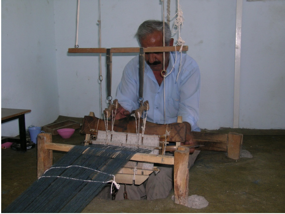
Şekil 35: Kuş Sistemi Tezgahta Görnüü
