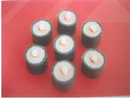
Resim 10. Deney için hazır hale getirilip akrilik bloklara yerleřtirilen örnekler
