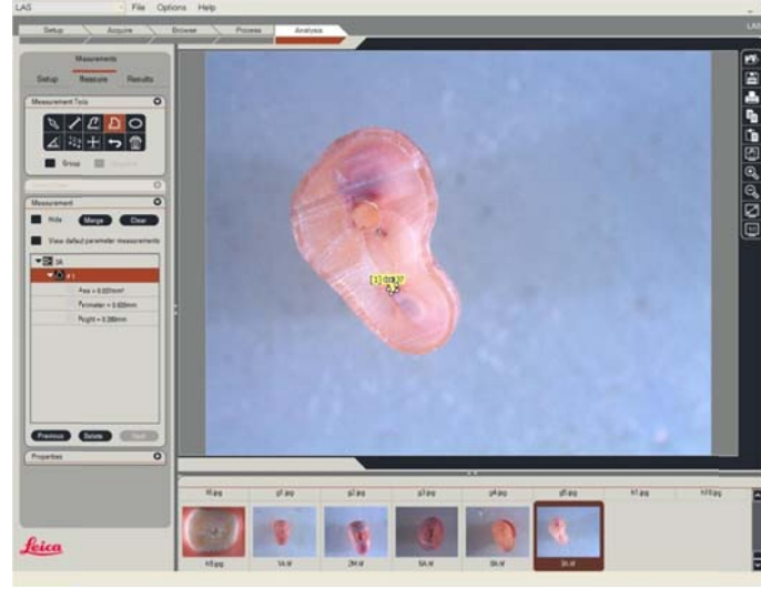
Resim 21. Örneklerin Stereomikroskopta Alan Ölçümlerinin Yapılması
