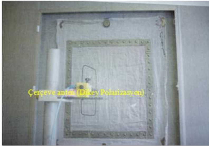
Şekil 55. Dikey polarizasyonda zayıflatma ölçümü (TÜBİTAK, 2013)
