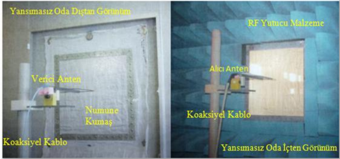
Şekil 52. Yansımaz odanın dıştan ve içten görünümü (TÜBİTAK, 2013)
