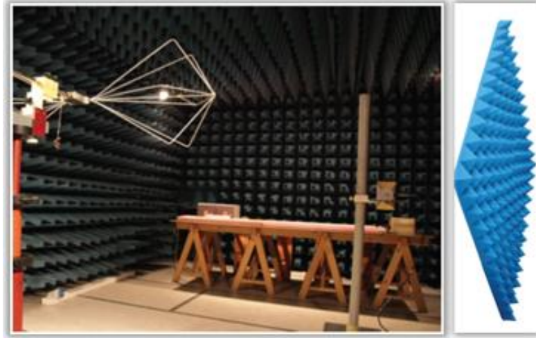
Şekil 26. Yarı yansız odanın içten görünümü, sünger esaslı EM dalga yutucu malzeme (B. Kılıç, 2010)
