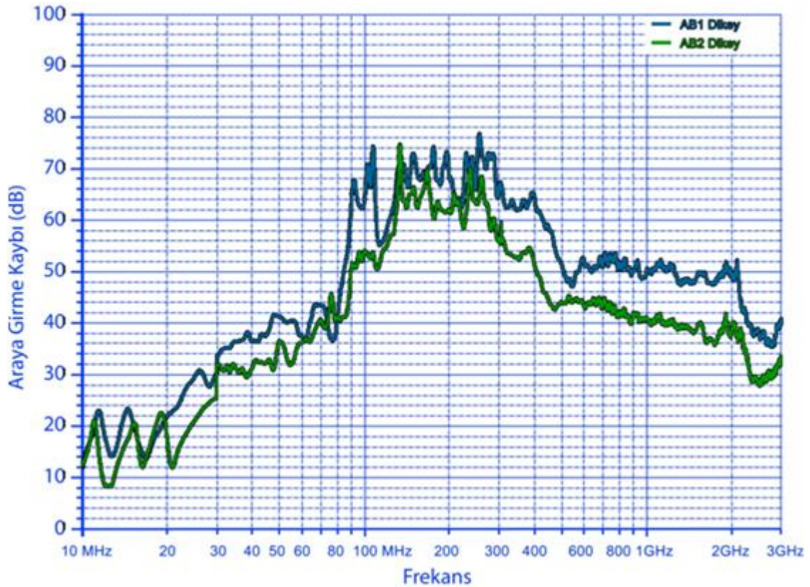
Şekil 80. AB1 ve AB2 alt atkı takviyeli çapraz atkı saten dokumalarının dikey polarizasyonda EMSE değerleri
