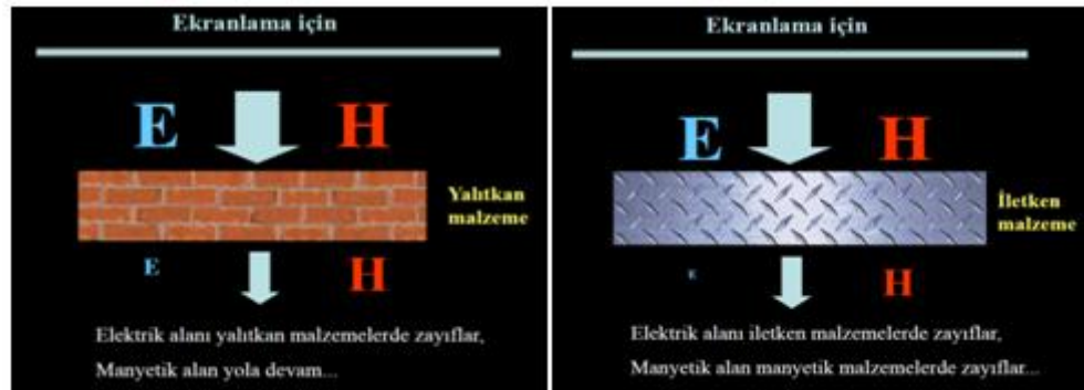
Şekil 24. Elektrik ve manyetik alanın malzemelerden geçişi (Kalenderli, 2005)
