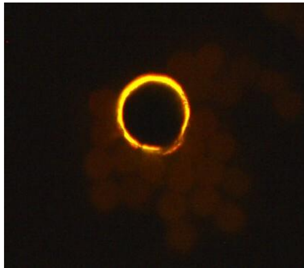
Şekil 44. Bakır filamentte ait kesit görüntüsü (880X) (Korteks İplik, 2013)
