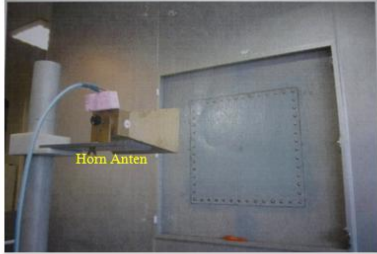
Şekil 59. Dikey polarizasyonda demir plaka zayıflatma ölçümü (TÜBİTAK, 2013)
