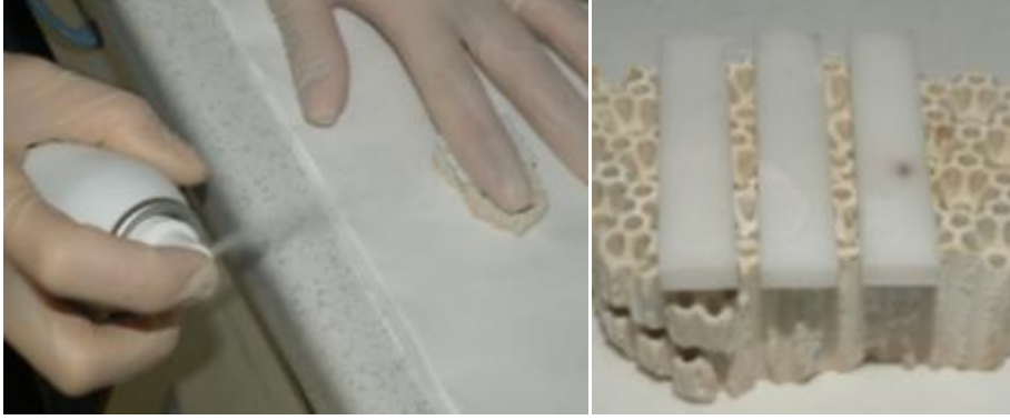
Resim 25: Örnekler üzerine glazür tabakasının uygulanması
