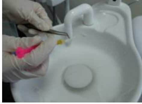
Resim 27: Örneklere HF asit jeli uygulanması
