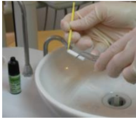
Resim 24: Örneklere zirkonya primer uygulanması
