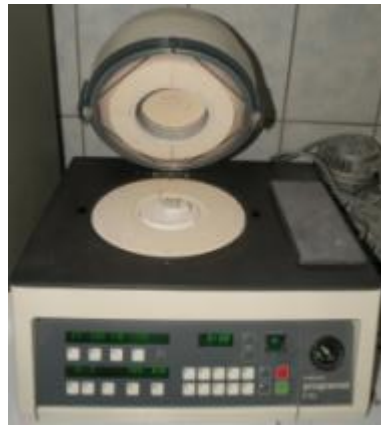
Resim 29: Örnekler kristalizasyon fırınlamasının (crystallization firing) uygulanması
