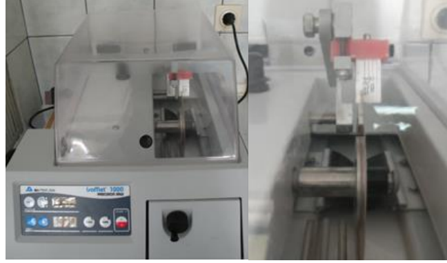
Resim 18: Kesme diskine paralel yerleştirilen zirkonya blok
