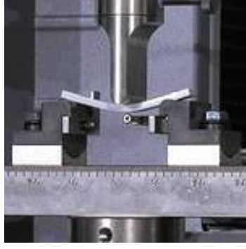
Resim 9: Üç nokta eğme testi düzeneği
