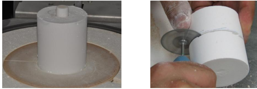
Resim 53: Restorasyonların revetmandan ayrılması
