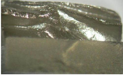
Resim 110: V-P grubunda gözlenen arayüzey kırık hattı (solda) ve kombine kırık (sağda) yüzeyine örnek
