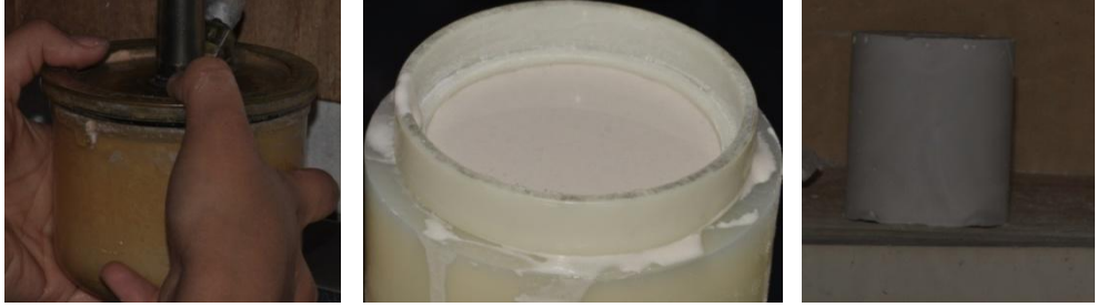
Resim 51: Revetmanın hazırlanması ve manşetin ön ısıtma fırınında bekletilmesi
