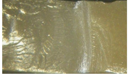
Resim 109: V-T grubunda gözlenen arayüzey kırık hattı (solda) ve kombine kırık (sağda) yüzeyine örnek
