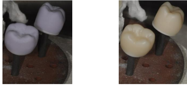
Resim 32: Seramiğin kristalizasyon fırınlaması öncesi ve sonrası
