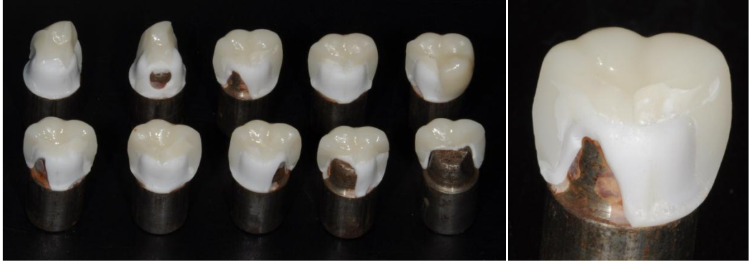
Resim 99: I-HP grubunda gözlenen kırık şekilleri.
