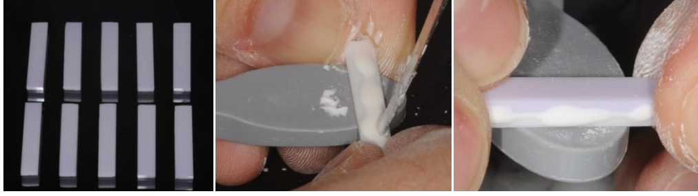
Resim 64: I-HP grubunda çubuk formundaki altyapı ve üstyapının birleştirilmesi
