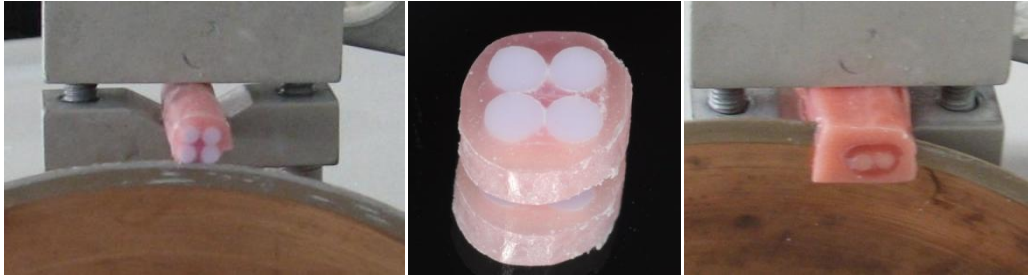
Resim 85: Disk formunda seramik örneklerin hazırlanması
