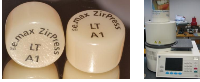
Resim 52: I-P grubunda kullanılan seramik ingotlar ve seramik fırını
