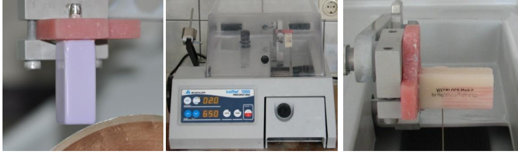
Resim 63: Akrilik taşıyıcıya sabitlenen seramik blokların çubuk formunda kesimi
