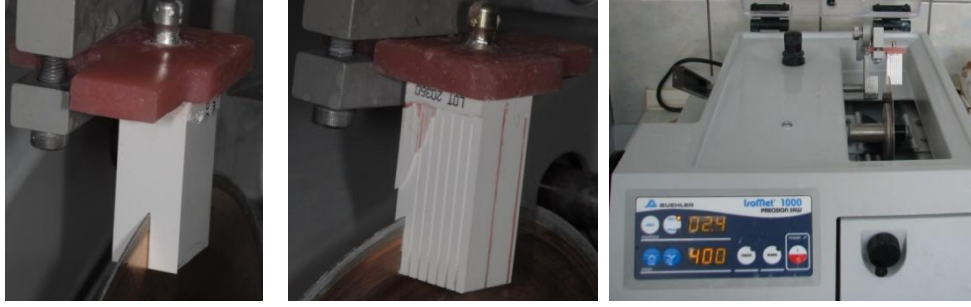
Resim 60: Zirkonya blokların döner disk ile kesilmesi
