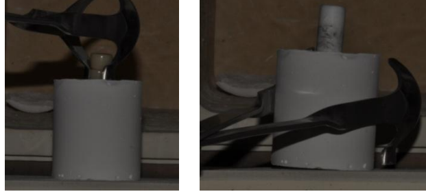
Resim 77: Mum eliminasyonu sonrası seramik ingotların yerleşimi
