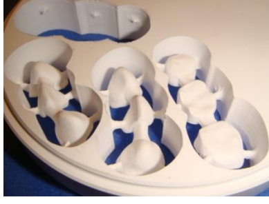
Resim 8: DC-Zirkon sistemi ile tam sinterize zirkonya bloktan frezelenmiş altyapı
