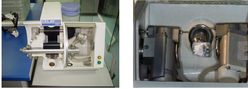
Resim 6: Celay sistemi ve kazıma ünitesi
