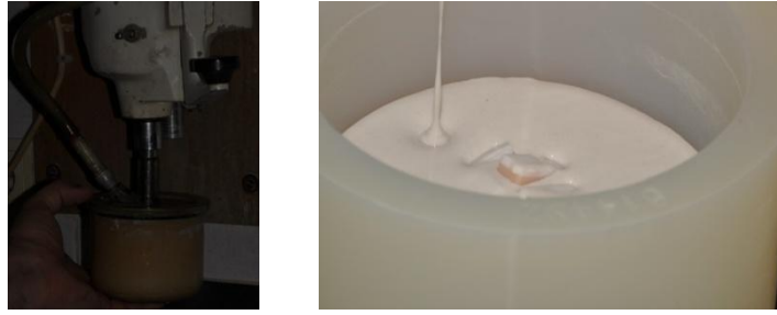
Resim 76: Revetmanın hazırlanması ve dökülmesi
