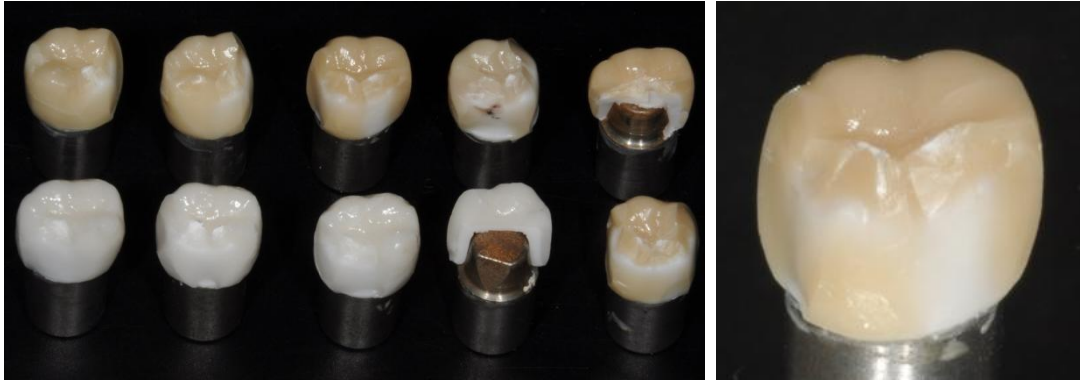
Resim 104: V-P grubunda gözlenen kırık şekilleri.
