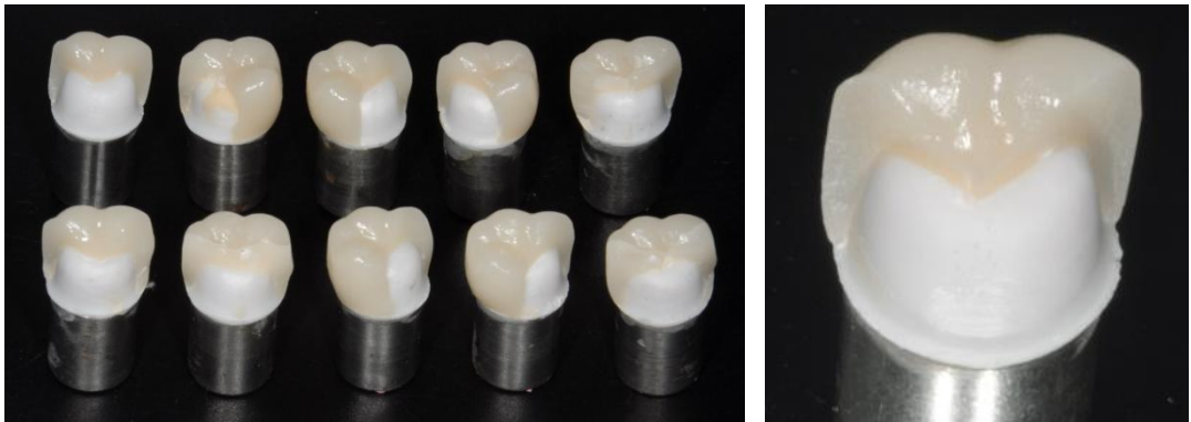
Resim 102: V-HP grubunda gözlenen kırık şekilleri.
