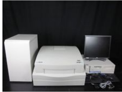
Şekil 7: DNA- DNA checkerboard hibridizasyon işleminin sonuçlarını almada kullanılan bilgisayar bağlantılı Storm Fluorimager mikroparka okuyucu
