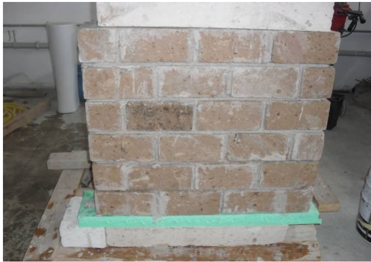
Şekil 6.1. Örme işlemi tamamlanmış duvar numunesi
