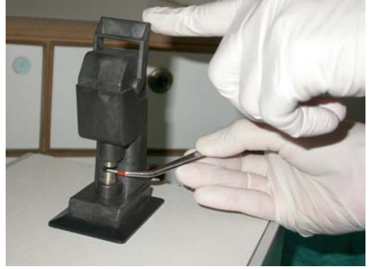
Şekil 15: Periotrona kağıt strip yerleştirilme işlemi
