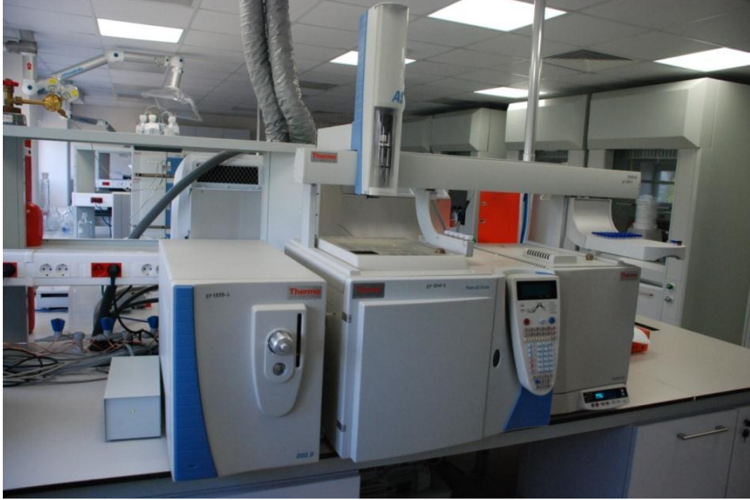
Şekil 27: Kombine Çalışan GC-MS, GC-FID ve Otomatik Örnekleyici Sistemi (FABAL: Ege Üniversitesi Eczacılık Fakültesi Farmasötik Bilimler Araştırma Laboratuvarı) (Fotoğraf: Bintuğ Öztürk)
