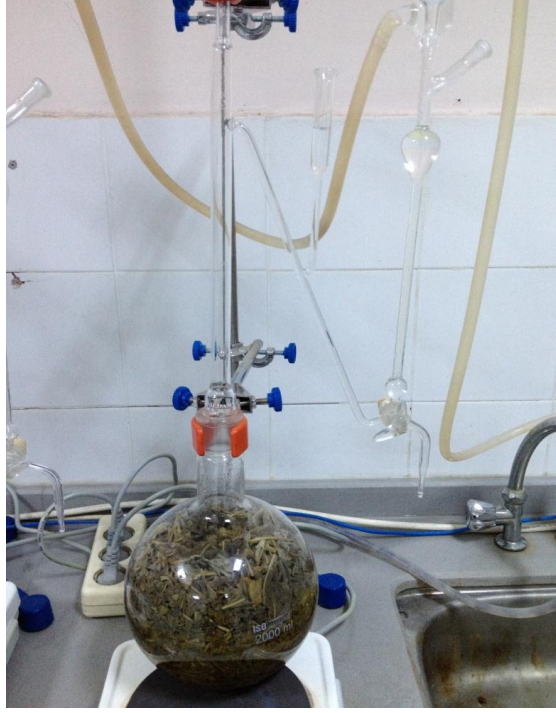
Şekil 26: Neo-Clevenger Tipi Distilasyon Düzeneği ve Balon İçindeki Bitkimiz Dorystoechas hastata (Fotoğraf: Damla Madencioğlu)
