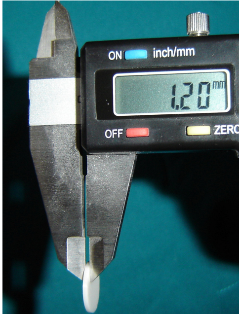
Resim 6: 1,2 mm kalınlığındaki örneklerin kumpas ile kontrol edilmesi
