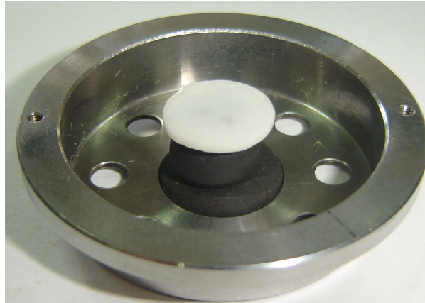
Resim 11: Örneklerin XRD cihazının tutucu parçasına yerleştirilmesi
