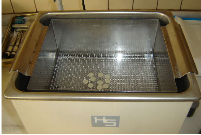
Resim 8: Yüzey işlemleri uygulanan örneklerin ultrasonik banyoda temizlenmesi
