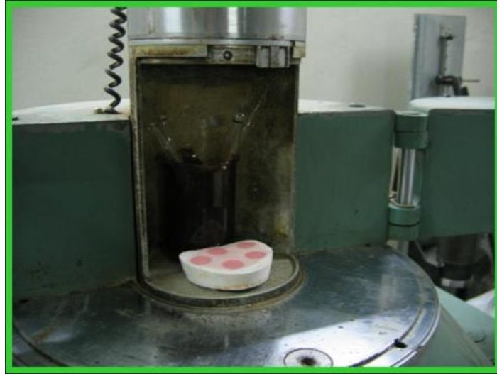
Resim 5: Gama cell 220 cihazı ve akrilik örneklerin cihaz içerisindeki görünümü
