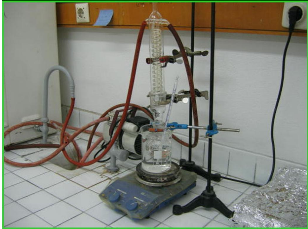
Resim 8: Örneklerdeki artık monomer salınımını gerçekleştirmek üzere hazırlanan düzenek
