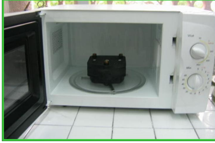
Resim 4: Mikrodalga enerjisiyle polimerizasyon yönteminde kullanılan mikrodalga fırın ve mufla
