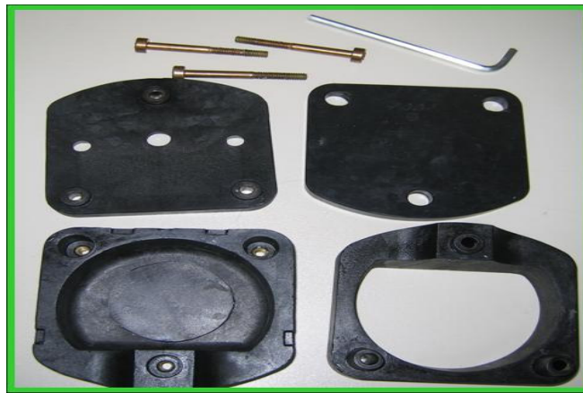
Resim 3: Mikrodalga enerjisiyle polimerizasyon yönteminde kullanılan fiber ile güçlendirilmiş plastik mufla ve polikarbon vidalar.
