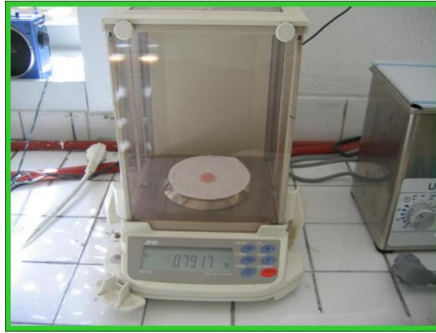
Resim 7: Hassas terazi ve örneğin tartılması
