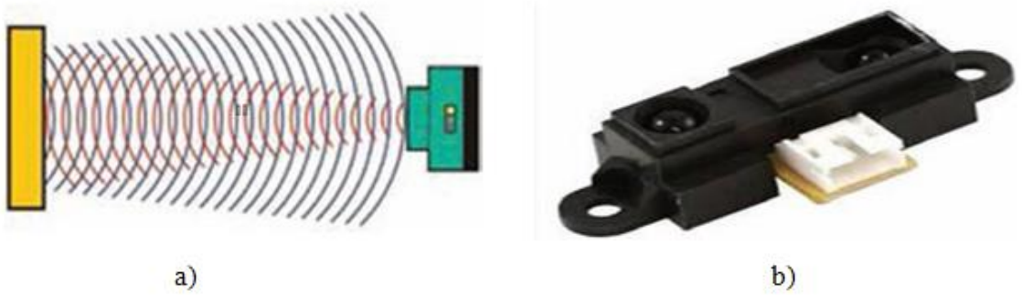
Şekil 3.19. a) Ultrasonik sensör ve dalga yansıması b) Kızıl ötesi sensör (URL-7)
