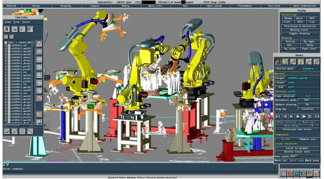
Şekil 3.23.Çevrim dışı programlama ile yapılmış bir çalışma örneği(URL-12)
