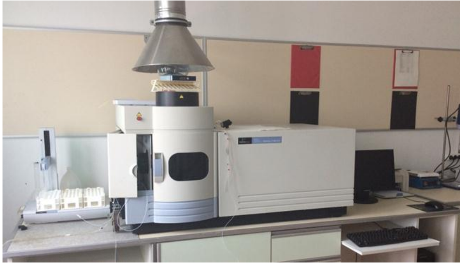
Şekil 3.1: Ağır metal muhtevasında kullanılan Perkin Elmer marka Optima 2100 DV OES (Optical Emission Spectrometer) cihazı.
