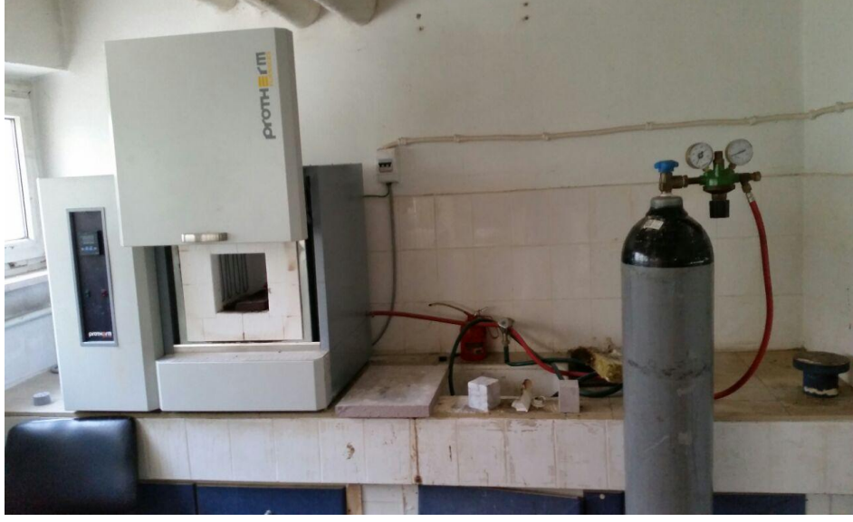
Şekil 3.5: Ham pirininin aktifleřtirilmesi için kullanılan etüv ve azot gazı
