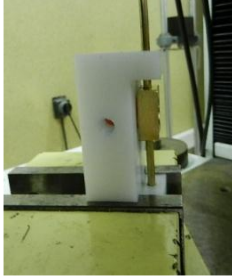
Resim 58: Makaslama test düzeneğinin yan cepheden görünümü
