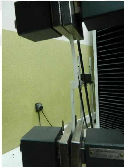
Resim 67: 180° soyulma testinin bitiş anı
