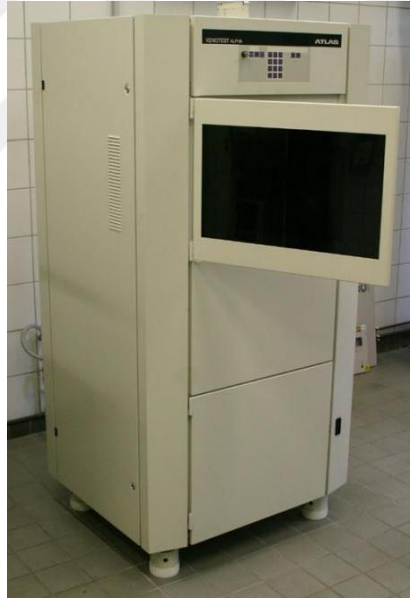
Resim 51: Xenotest Alpha (SDL Atlas, LLC Rockhill, SC) yaşlandırma cihazı (130)
