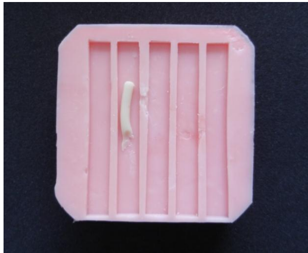
Resim 35: Kalıbın içine kompozit uygulanması
