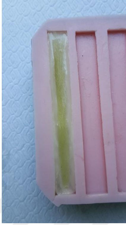
Resim 3: Kompozit üzerine yerleştirilmiş fiber demeti.
