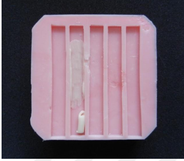
Resim 36: Kalıbın içine kompozitin yayılması.
