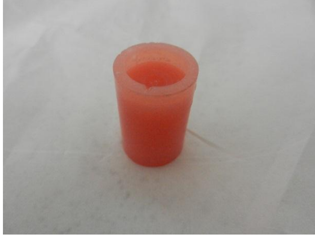
Resim 8: Ankastre içine hazırlanan tersine konik deliğin yandan görüntüsü
