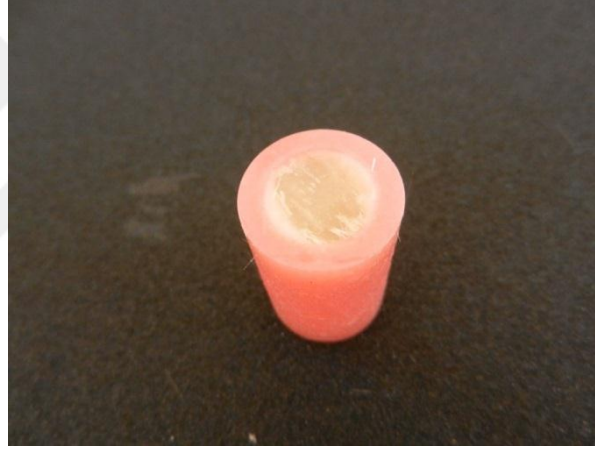
Resim 14: Fiber liflerinin tabana paralel yerleştirilişi.
