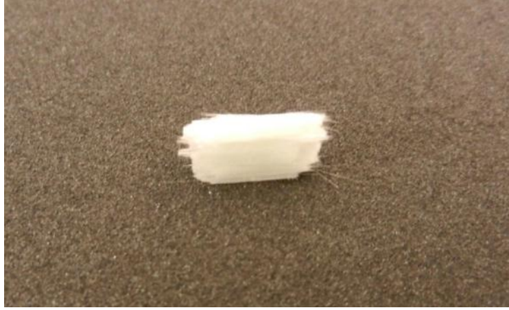
Resim 12: Silan ajanı (Monobond-S, İvoclar Vivadent Schaan, Liechtenstein) ile ıslatılmış fiber lifleri.
