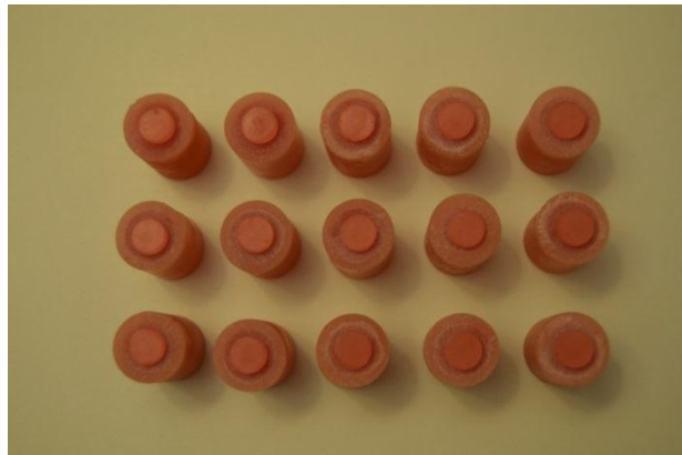
Resim 20: 8 mm çap ve 3 mm boyundaki mum silindirlerin örnekler üzerine yerleştirilmiş hali (ışık ile sertleşen kaide materyali grubu)
