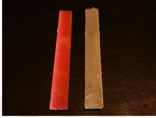
Resim 68: 180° Soyulma test örneklerinde adeziv kopma
