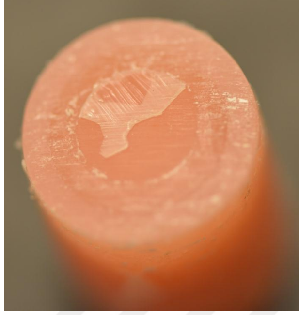
Resim 63: Örneklerde oluşan miks kopma
