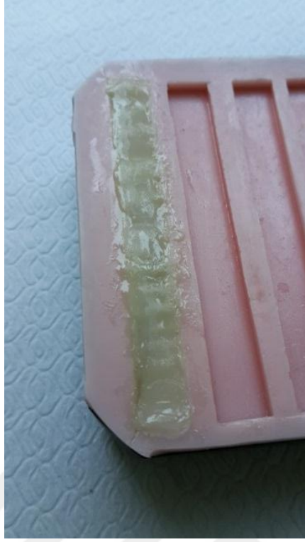
Resim 4: Fiber demetinin zerinin kompozit ile kaplanması.
