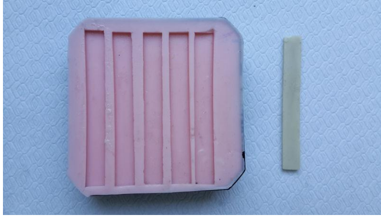
Resim 5: rneęin kalıbın iinden ıkarılmıř ve kenarları 60 numara zımpara ile dzeldilmiř hali.
