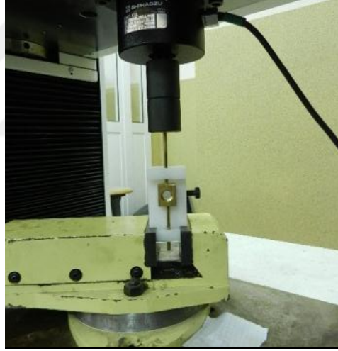
Resim 59: Makaslama test düzeneğinin üniversal test cihazına bağlanmış hali
