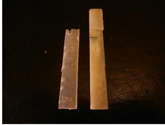
Resim 69: 180° Soyulma test örneklerinde miks kopma
