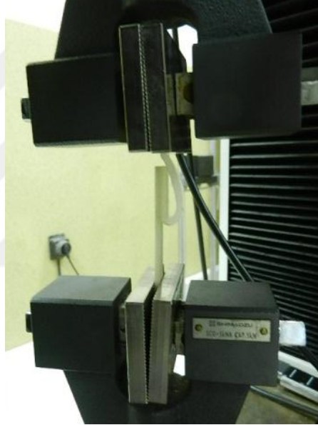
Resim 65: 180° soyulma testinde örneğin alete sabitlenmesi
