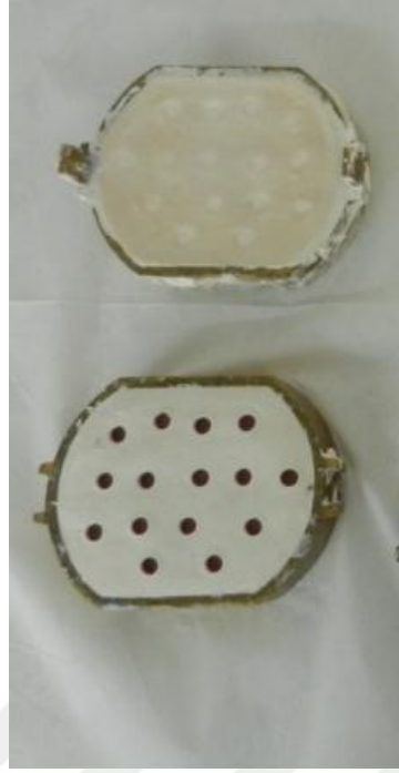
Resim 24: Primer (G611 platinum primer, Principality Medical, UK) uygulanmış mufla içindeki örnekler.
