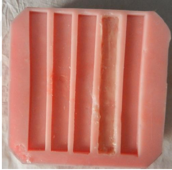
Resim 1 : Örnek alt yapısı eldesi için hazırlanan silikon kalıp
