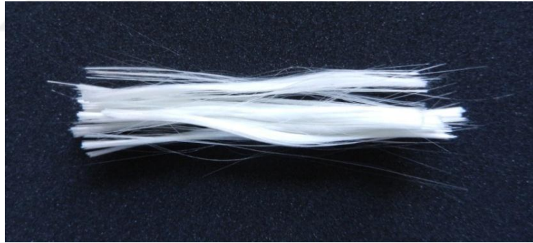
Resim 32: Kalıp boyutlarında kesilen tek y nl  fiber demetleri.
