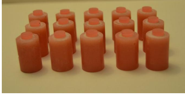
Resim 21: Mum silindirlerin örnekler üzerine yerleştirilişi (FRC grubu)
