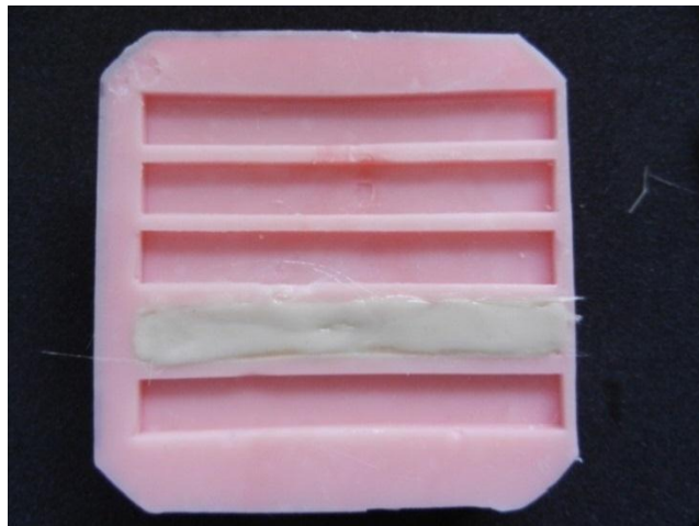
Resim 39: Fiber demetinin üzerinin kompozit kaplanması
