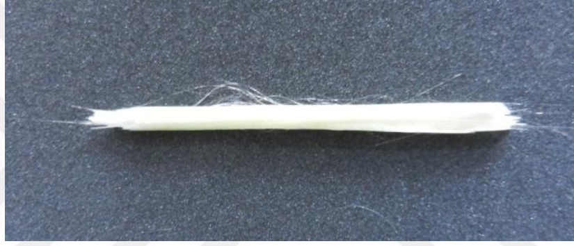
Resim 34: Bonding ajanı uygulanan fiber demeti
