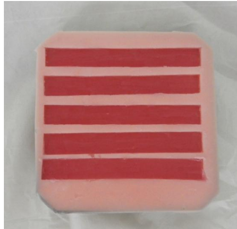
Resim 31: Tabakalama tekniği uygulanan ışık ile sertleşen kaide materyali grubu alt yapılarının kalıp içindeki görüntüsü.
