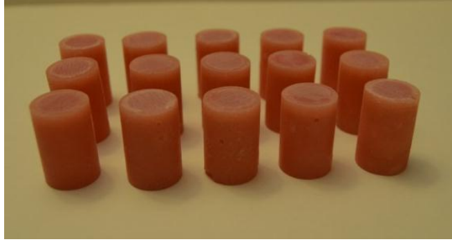
Resim 17: Zımparalanmış örnek yüzeyleri (ışık ile sertleşen kaide materyali grubu)
