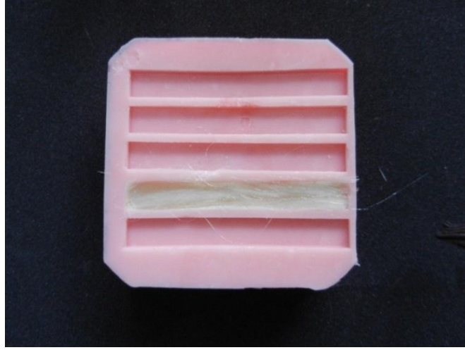
Resim 38: Fiber demetinin kalıba yerleştirilmesi
