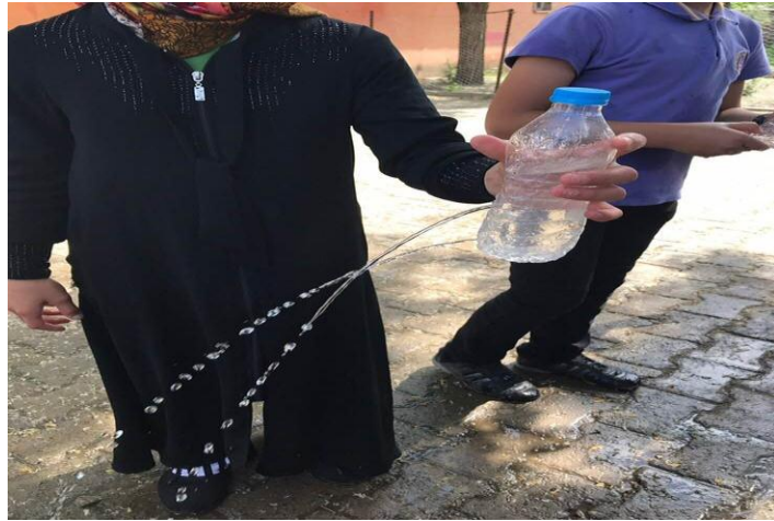
Şekil 7. Sıvı basıncı ile yükseklik arasındaki ilişki
