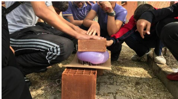
Şekil 5. Yüzey alanın artırılması ile basıncın değişimi
