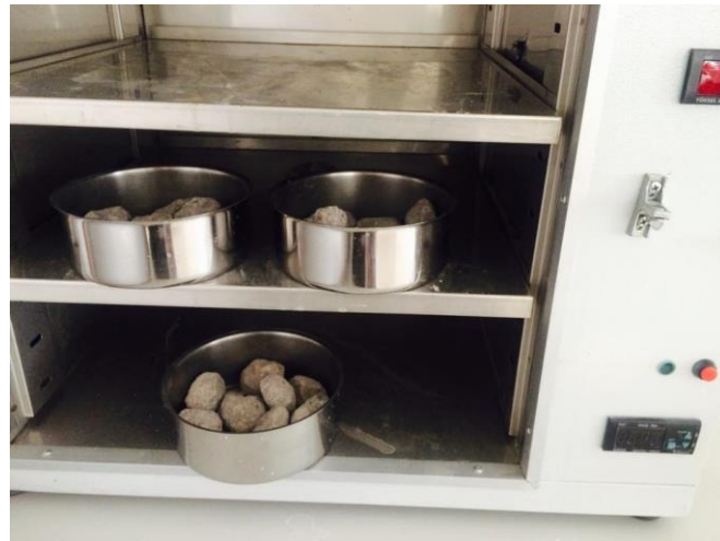
Şekil 3.19: Suda dağılmaya karşı duraylılık (slake durability) deneyi için hazırlanıp etüve konan örnekler.
