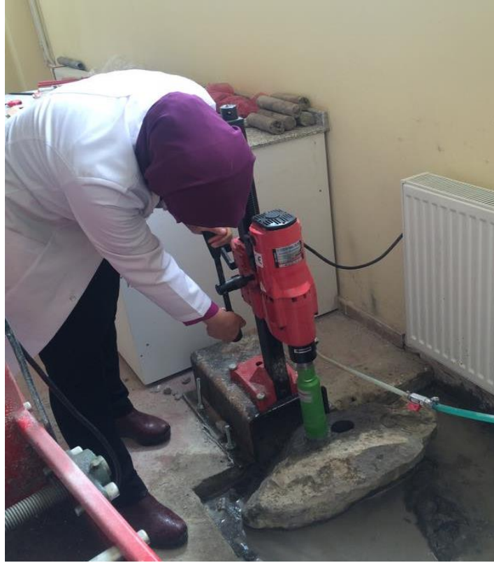
Şekil 3.10: Laboratuvarda döner başlıklı cihazla karot alımı.
